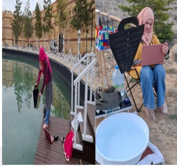
Şekil 4.9. Log Periyodik Dipole Anten Su Yüzeyi Referans Ölçümleri
