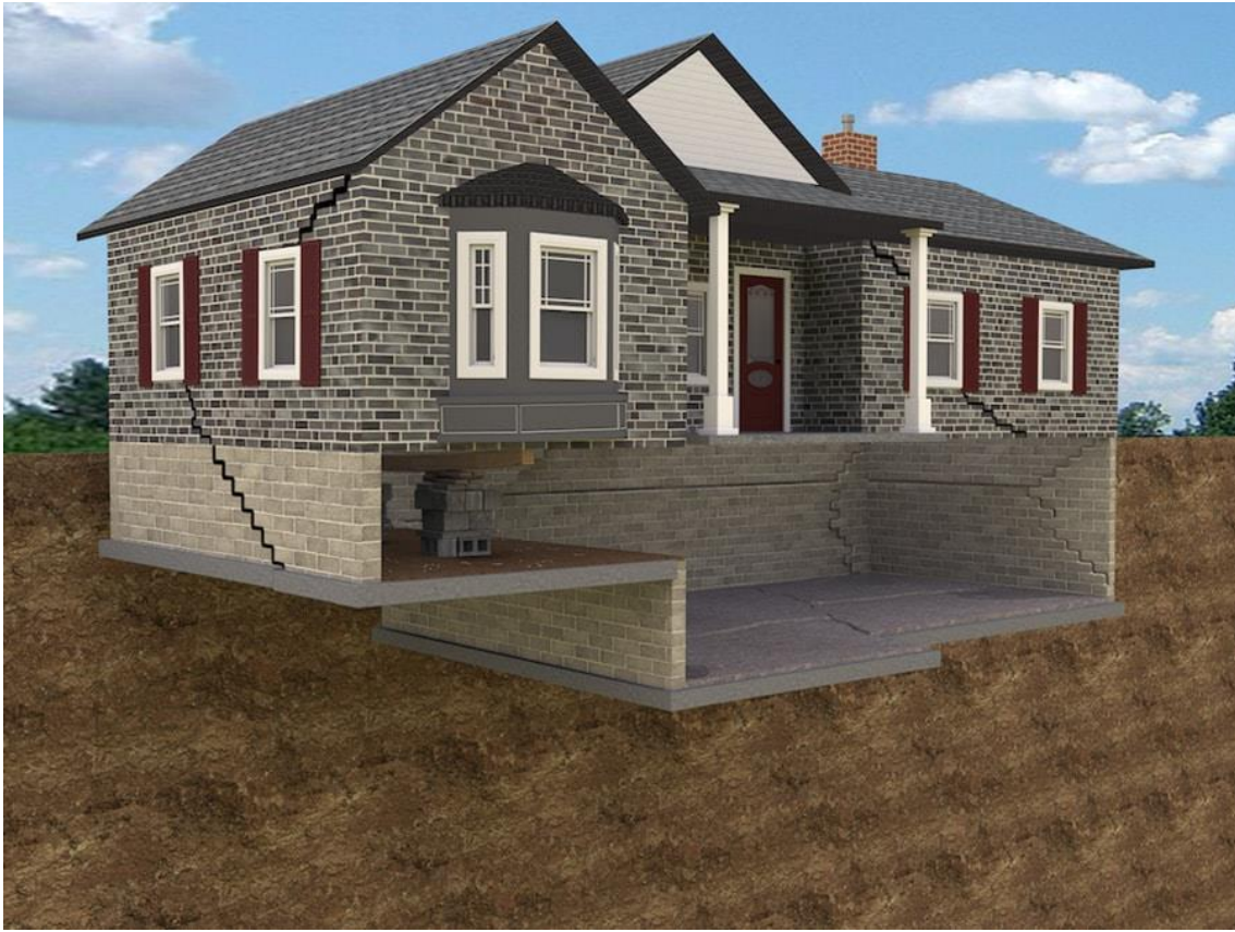
Şekil 1.1. Zemindeki oturma problemi sonrası oluşan yapısal hasar
