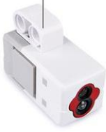
Şekil -12: Işık/Renk Sensörü
