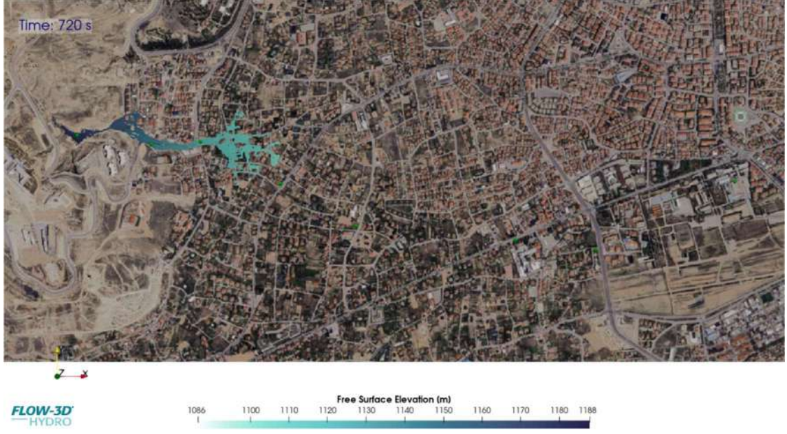
Şekil 6.24 .720. sn'de 2B (Haritalı) Analizler Sonucu Oluşan Serbest Su Yükseklik Dağılımı
