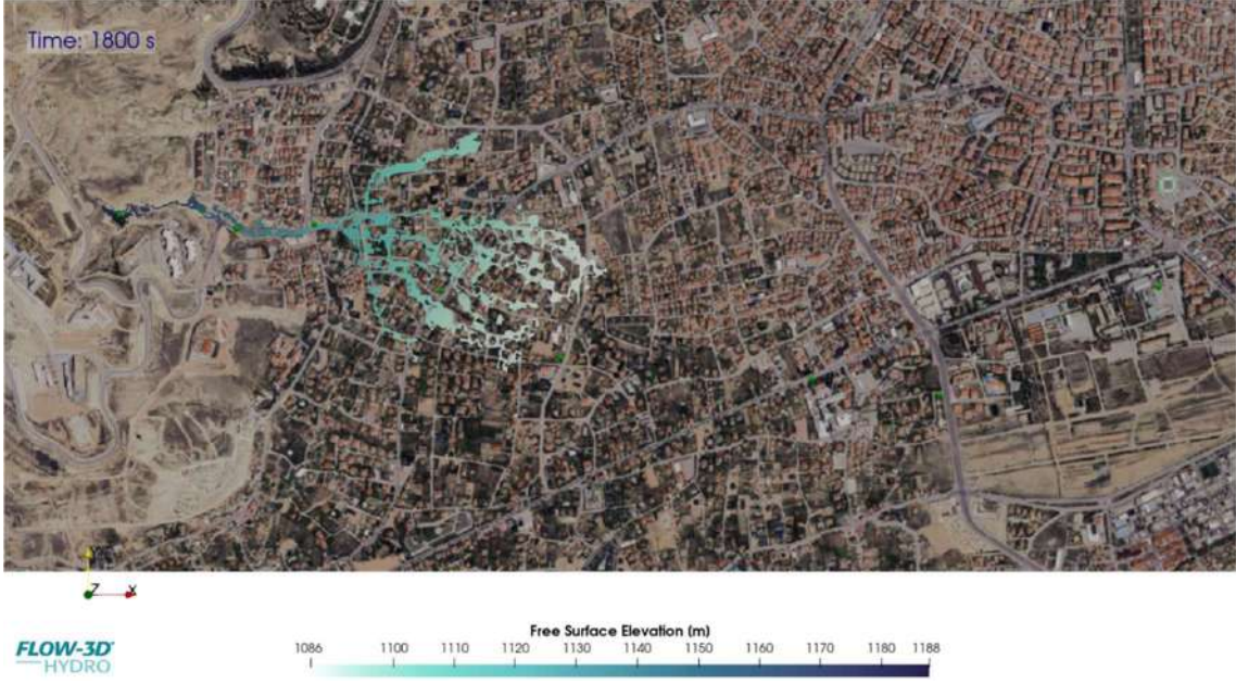
Şekil 6.36. 1800. sn'de 2B (Haritalı) Analizler Sonucu Oluşan Serbest Su Yükseklik Dağılımı
