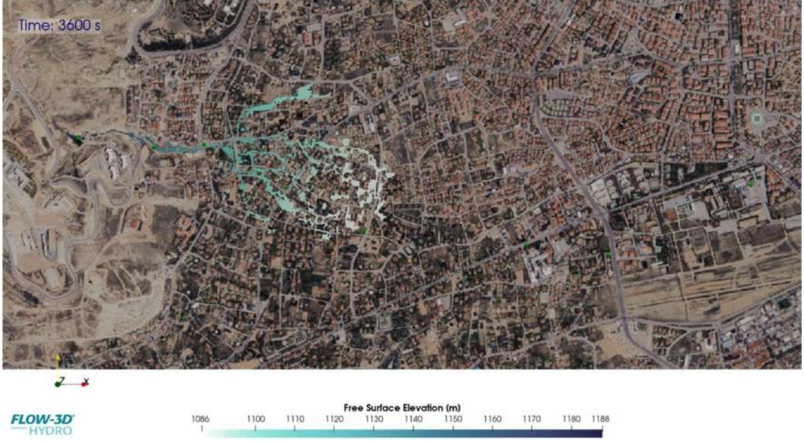
Şekil 6.40. 3600. sn'de 2B (Haritalı) Analizler Sonucu Oluşan Serbest Su Yükseklik Dağılımı
