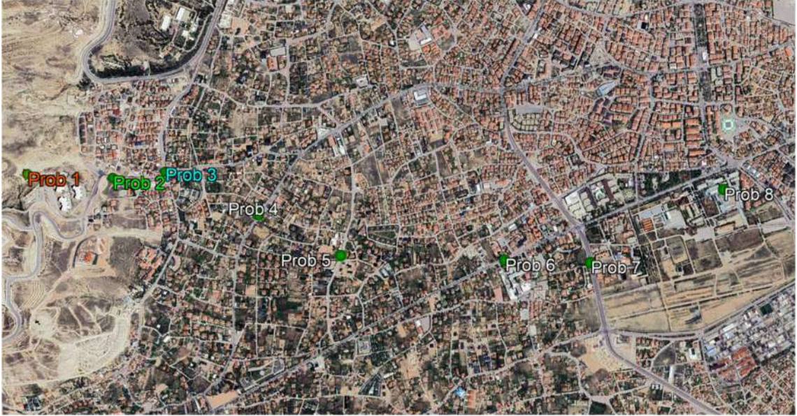
Şekil 6.42. FLOW-3D Taşkın analizinde önemli noktalara atılan prob noktaları
