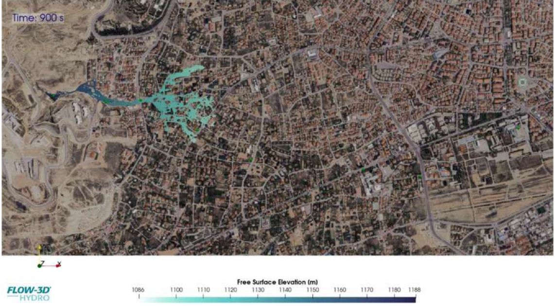
Şekil 6.28. 900. sn'de 2B (Haritalı) Analizler Sonucu Oluşan Serbest Su Yükseklik Dağılımı
