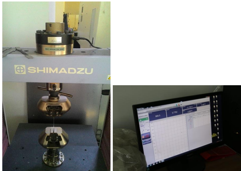
Şekil 6.10. Çekme cihazı ve deney düzeneği
