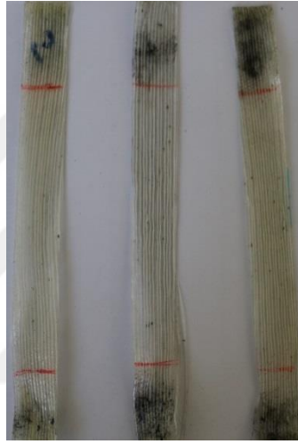
Şekil 7.7. Çekme testinden sonra tek yönlü hazırlanan numune
