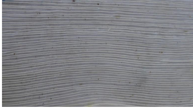
Şekil 6.8. Pres işleminden sonra tek yönlü yönlendirilerek üretilen kompozit malzeme
