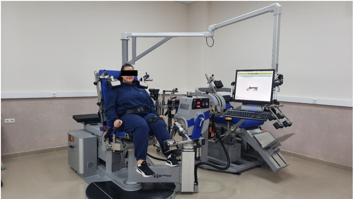
Şekil 3.5. Isomed 2000 (D&R Ferstl GmbH, Hemau, Almanya) izokinetik dinamometre sistemi.
