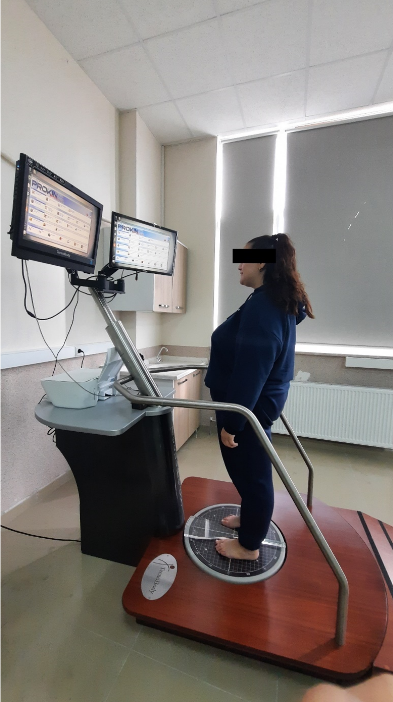
Şekil 3.3. Tecnobody (PK-252-İtalya) izokinetik denge ölçüm sistemi.
