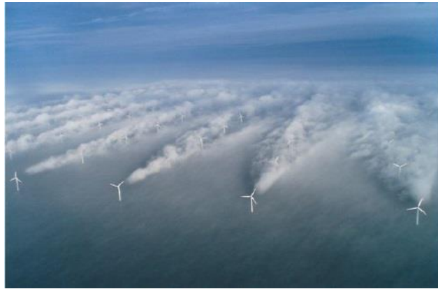
Şekil 4.2: Türbinlerinden geçen rüzgârın hava akış görünümü
