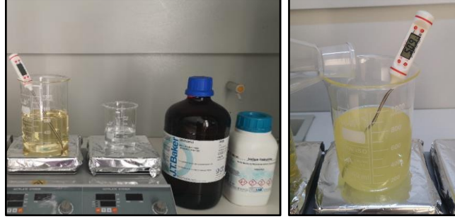
Şekil 3.3. Aspir yağına alkol ve katalizör ilave edilmesi ve reaksiyonun başlangıcı
