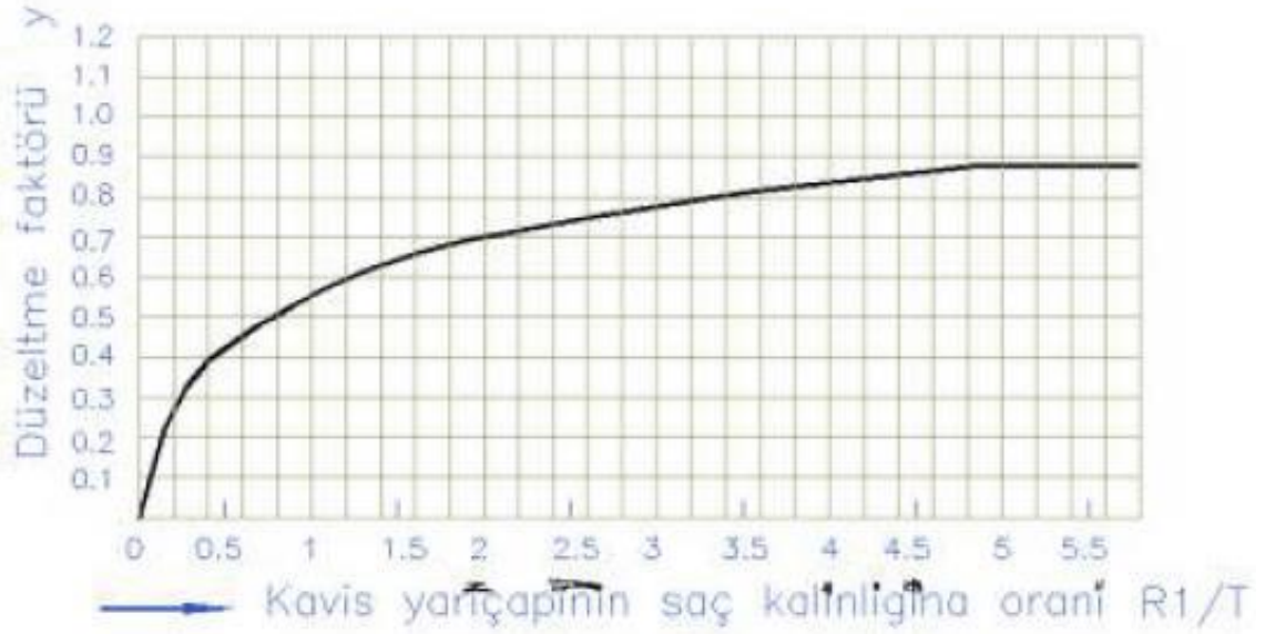
Şekil 26. Bükme kavis yarıçapının sac malzeme kalınlığına oranı R1/T oranına göre düzeltme faktörü (Yurci, M.E., 1991)
