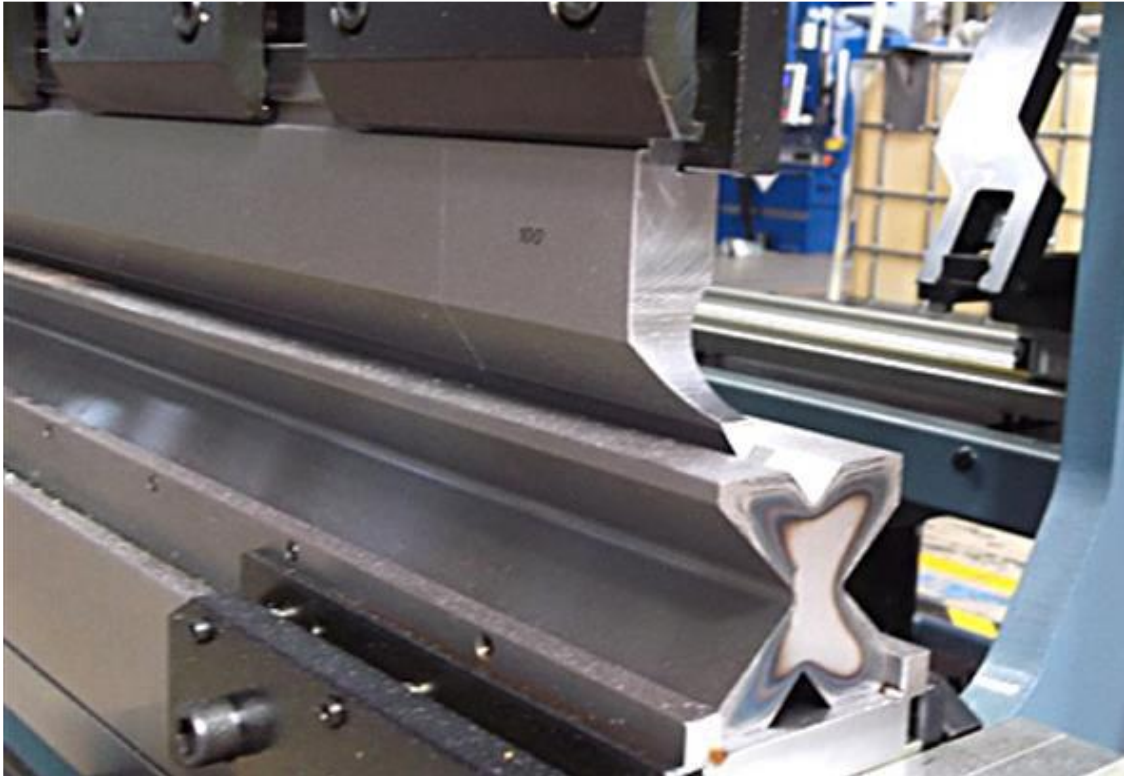
Şekil 9. Multi-V kalıp (1-V genişliği 50 mm, 2-V genişliği 35 mm, 3-V genişliği 22 mm, 4-V genişliği 16 mm)
