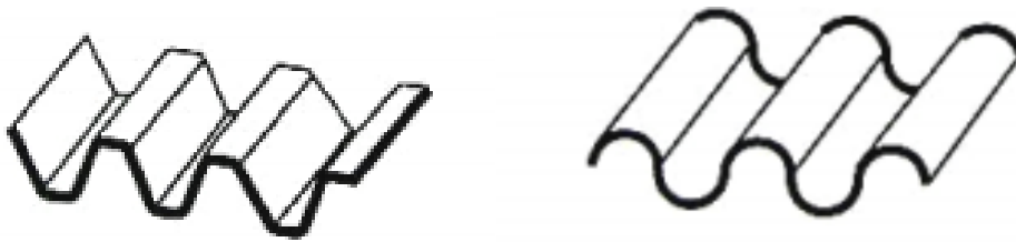
Şekil 22. Oluk büküm kalıbında bükülen parçalar
