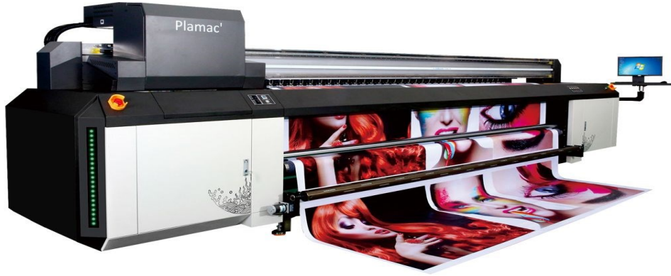
Görsel 64. Solvent bazlı baskı makinesi (www.efivutek.com Erişim Tarihi: 21.12.2021).
