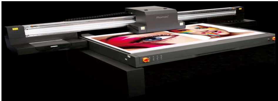
Görsel 65. UV solvent bazlı baskı makinesi (www.efivutek.com Erişim Tarihi: 21.12.2021).
