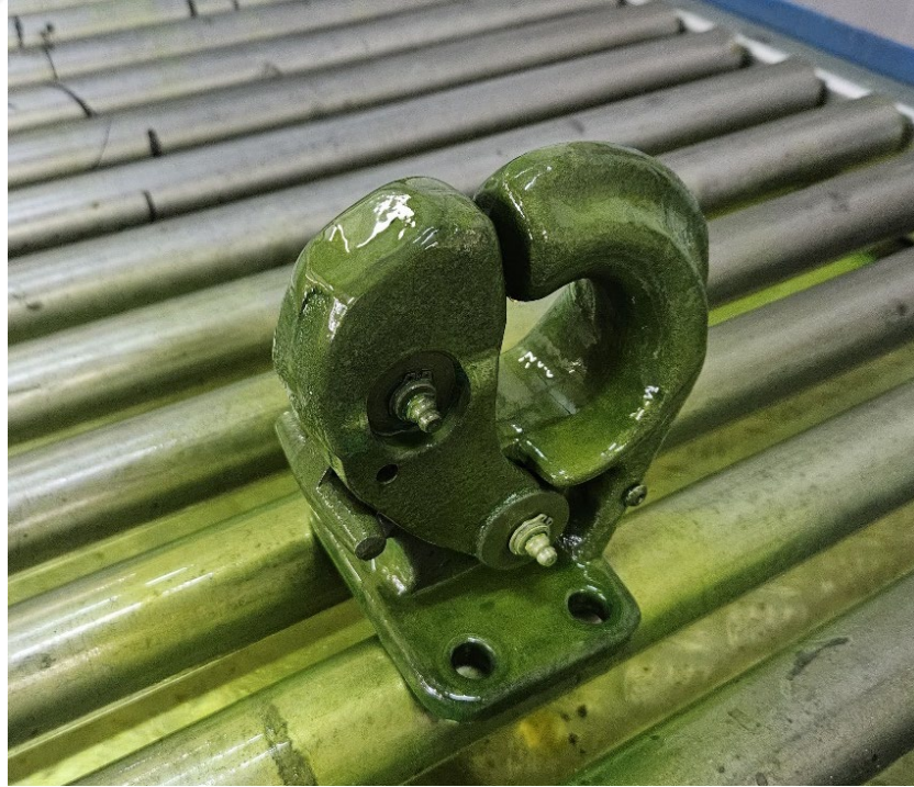
Şekil 3.11. Sıvı penetrant havuzundan çıkarılan ve süzülmeye bırakılan malzeme
