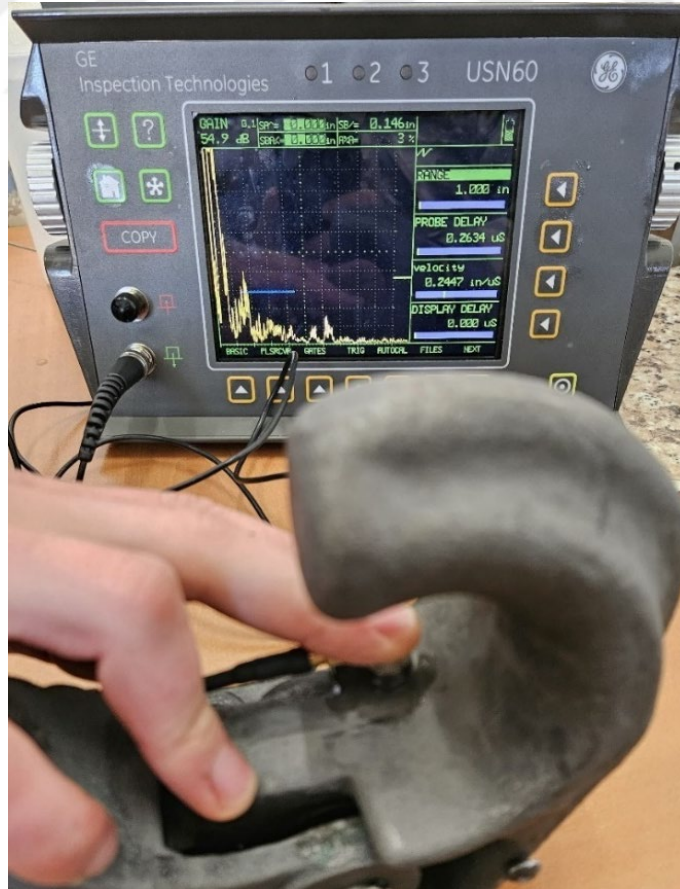
Şekil 3.6. Ultrasonik test yapılan uçak çeker kancası
