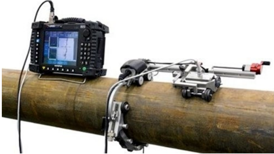
Şekil 2.10. Girdap akım testi uygulanan bir malzeme örneği
