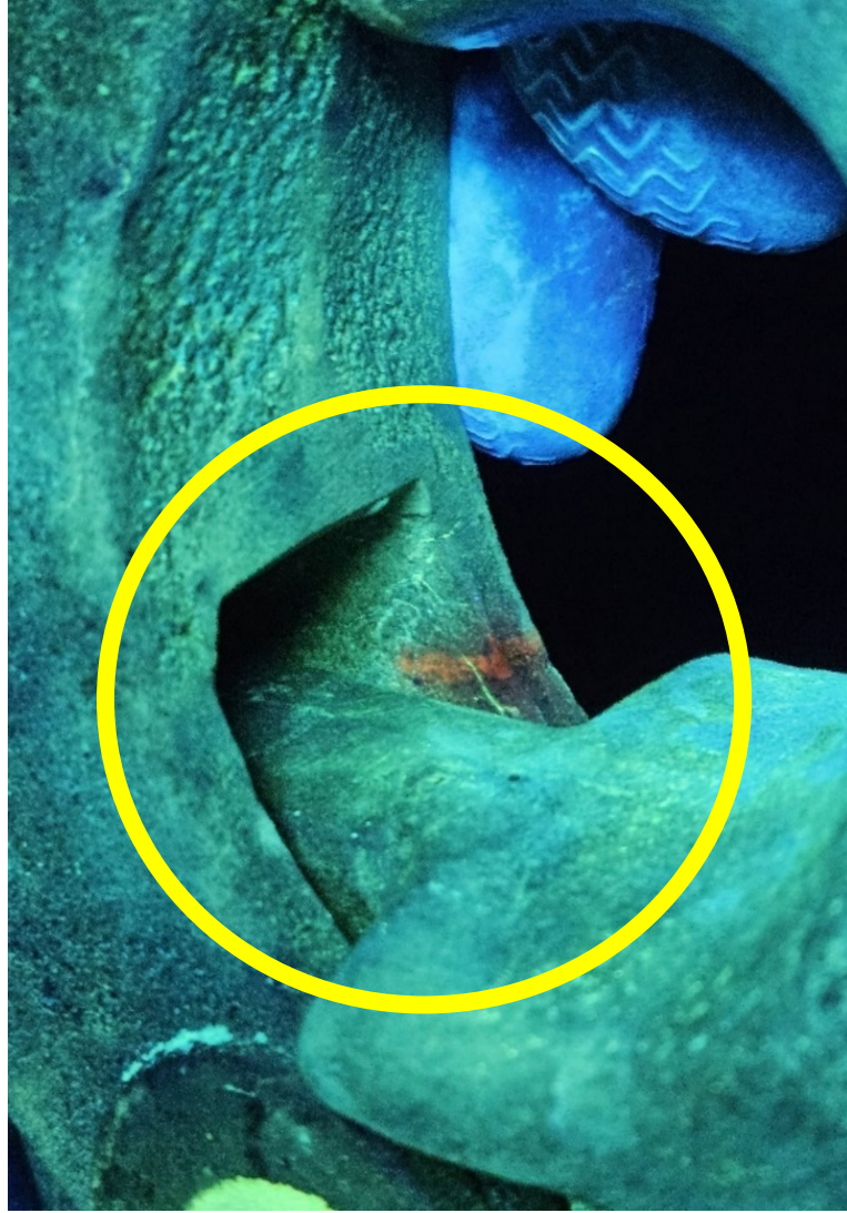
Şekil 4.5. Test sonrası takip edilen süreksizlikler
