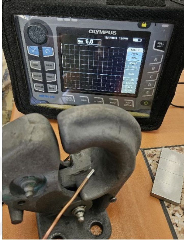
Şekil 4.1. Girdap akımı (Eddy current) testi yapılan malzeme
