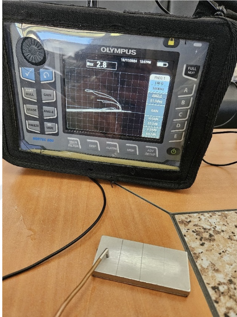
Şekil 3.3. Kalibre bloğu ile kalibresi yapılan Girdap Akımı (Eddy Current) test cihazı
