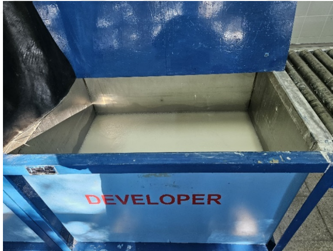
Şekil 3.15. Developer sıvı havuzu
