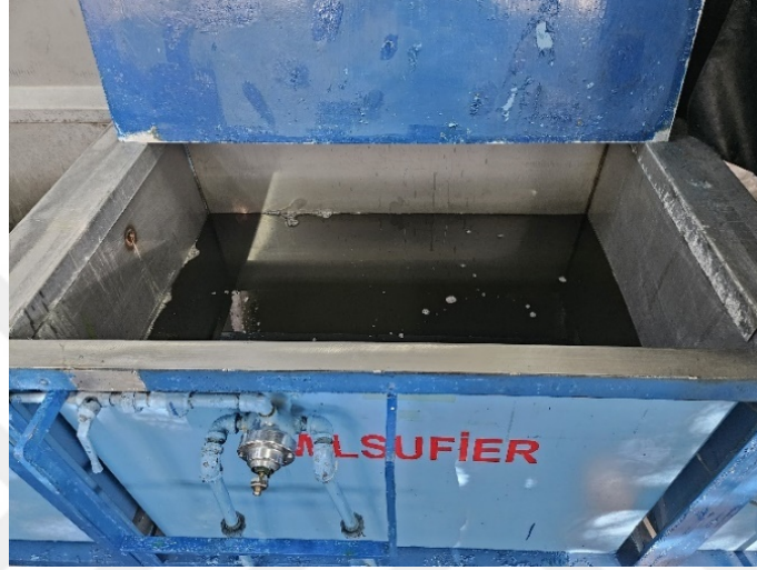
Şekil 3.12. Sıvı penetrant test donanımına ait emulsifier havuzu
