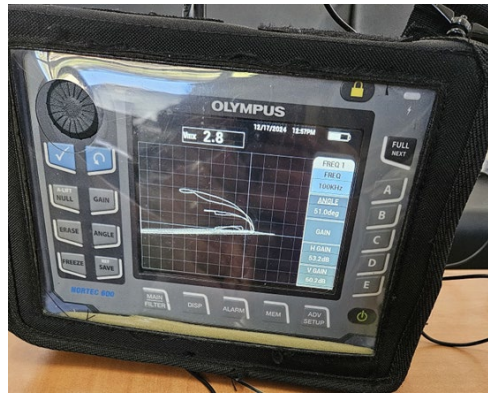
Şekil 3.2. Girdap Akımı (Eddy Current) test cihazı
