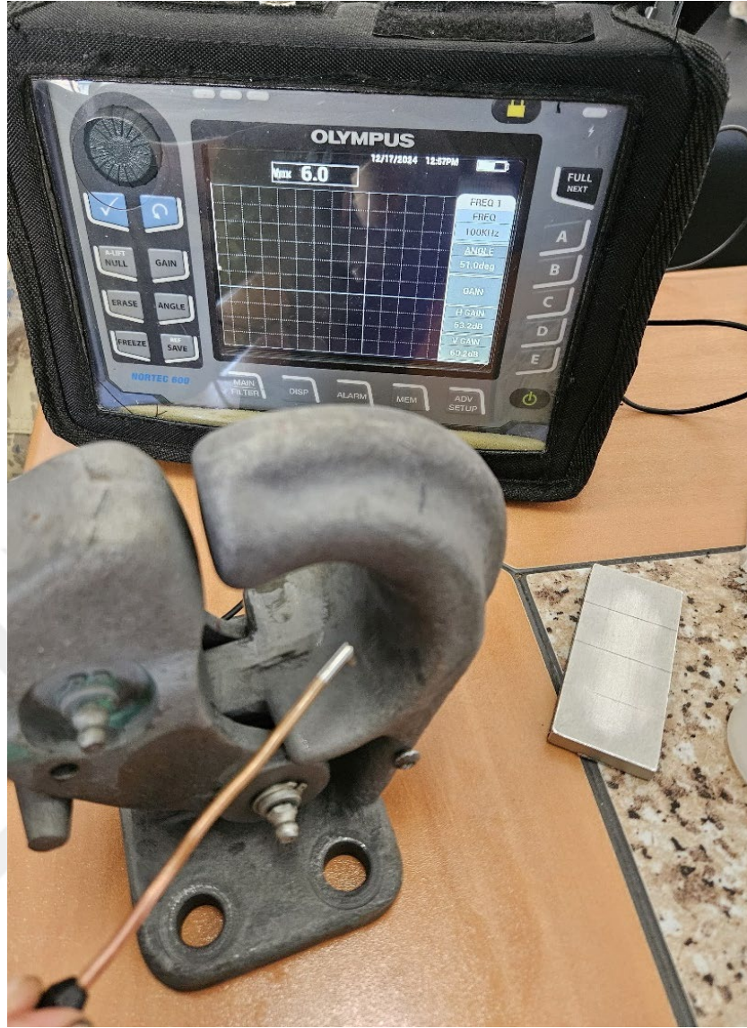
Şekil 3.4. Girdap Akımı (Eddy Current) testi yapılan uçak çeker kancası
