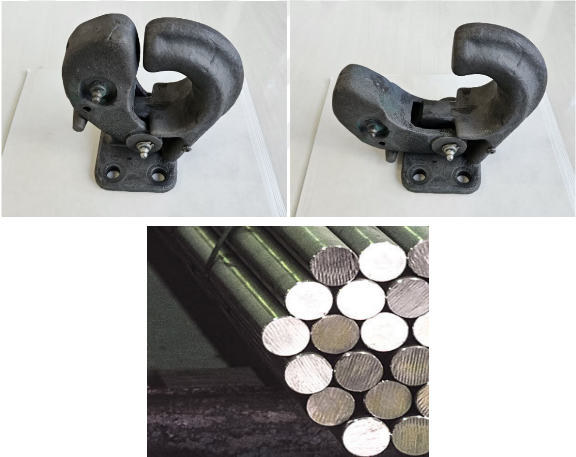
Şekil 3.1. Test edilen hava aracı çeker kancası ve AISI 4130 alaşımli çelik
