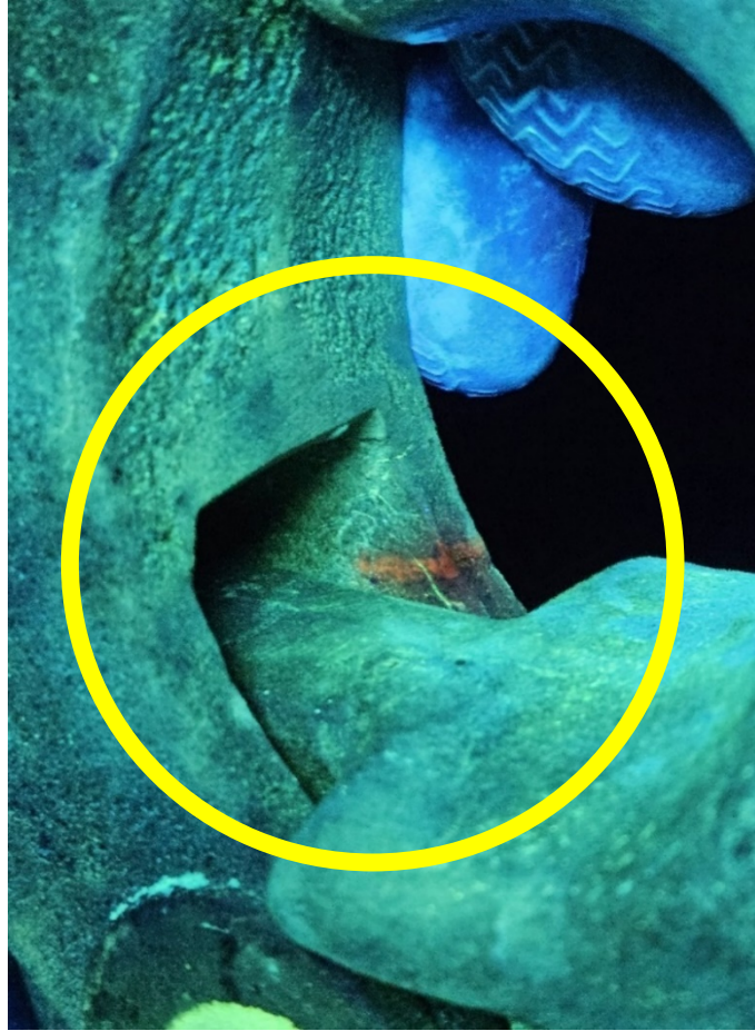
Şekil 3.17. Sıvı penetrant testi tamamlanan çeker kancası
