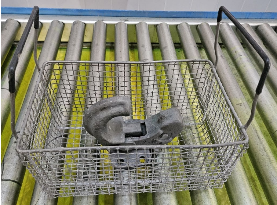
Şekil 3.9. Sıvı penetrant test için malzemenin süzgeçlenmesi
