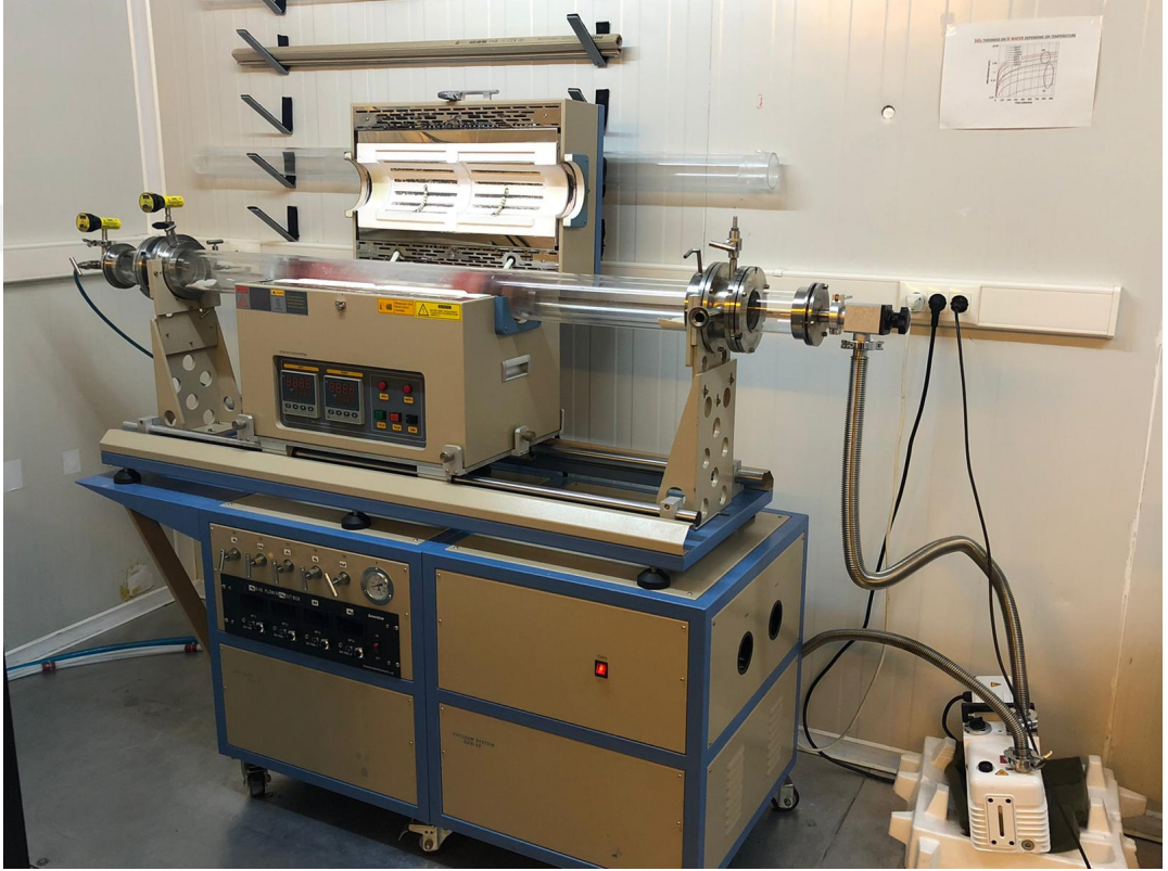
Şekil 3.5. MTI-OTF 1200 Düşük Basıncılı Kimyasal Buhar Biriktirme (CVD) Cihazı
