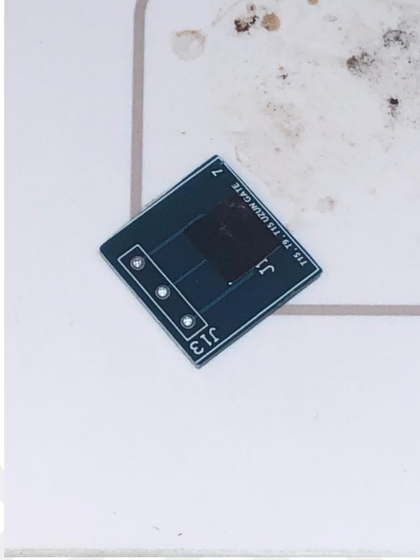
Şekil 3.13. Grafenin Baskı Devre Kartı Üzerine Transferi
