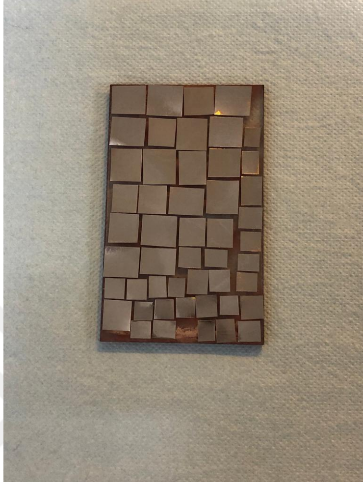
Şekil 3.4. Bakırların Kuvarz Zemine Yerleştirilmesi
