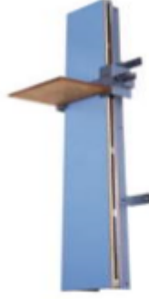
Şekil 1. Holtain marka stadiometre
