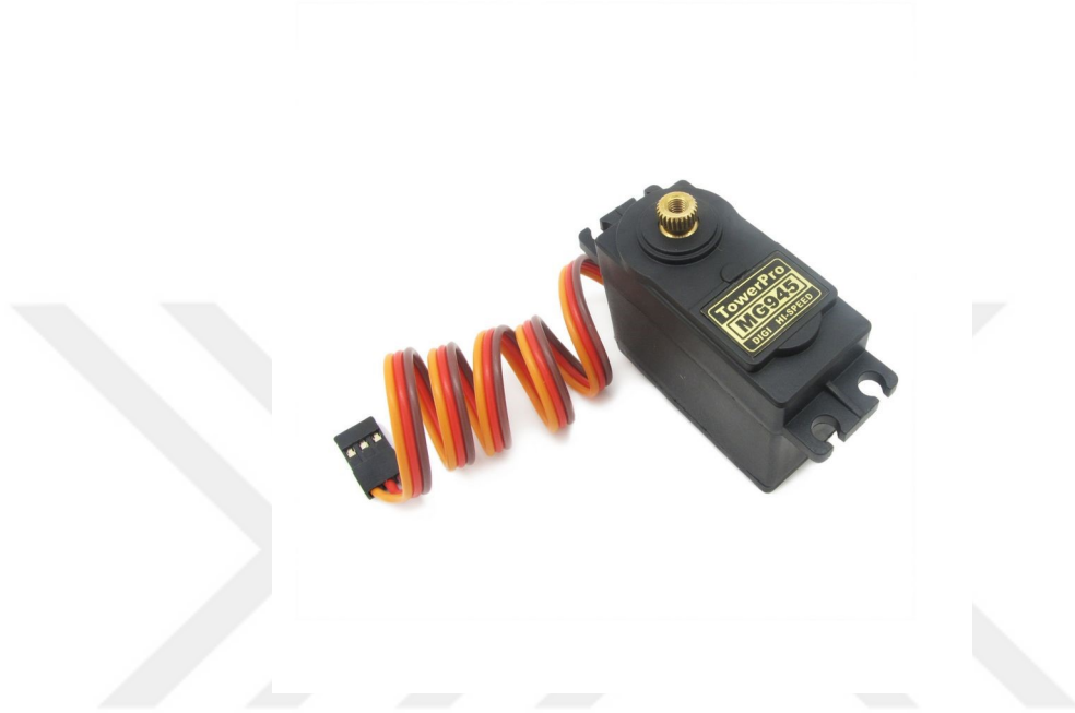
Şekil 3.15. İki eksenli servo mekanizmasında kullanılan servo motor
