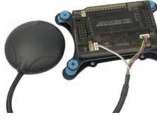
Şekil 3.29. APM' in GPS bağlantısı yapılmış hali
