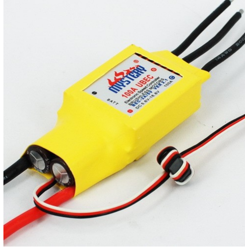
Şekil 3.17. Ana motoru kontrol etmeyi sağlayan 100A ESC
