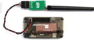
Şekil 3.20. Telemetri ekipmanları ve bağlantısı ( 2)
