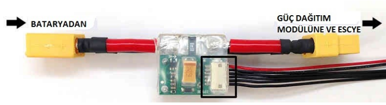
Şekil 3.11. Arducopter ve Pixhawk için tasarlanmış ortalama 5.3 volt üreten güç dağıtım modülü
