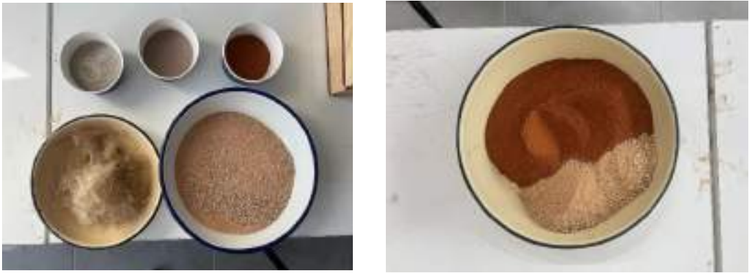
a. Kireç harçları için hazırlanan malzemeler.
