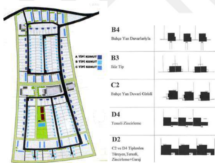
Şekil 3.1 Jansen'in Bahçelievler Yerleşim Planı ve Yerleşkede Uygulanan Konut Tipleri (Kansu, 2009, İlerisoy ve Tuncel, 2016)
