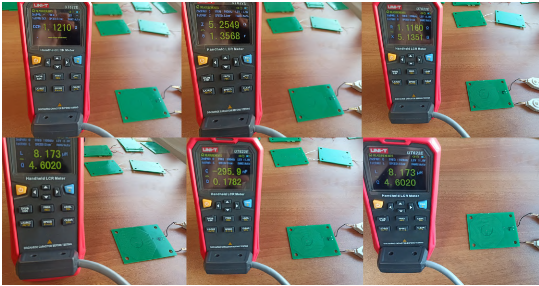
Şekil 3.40. LCR metre ile çeşitli bobinlerin test edilmesi
