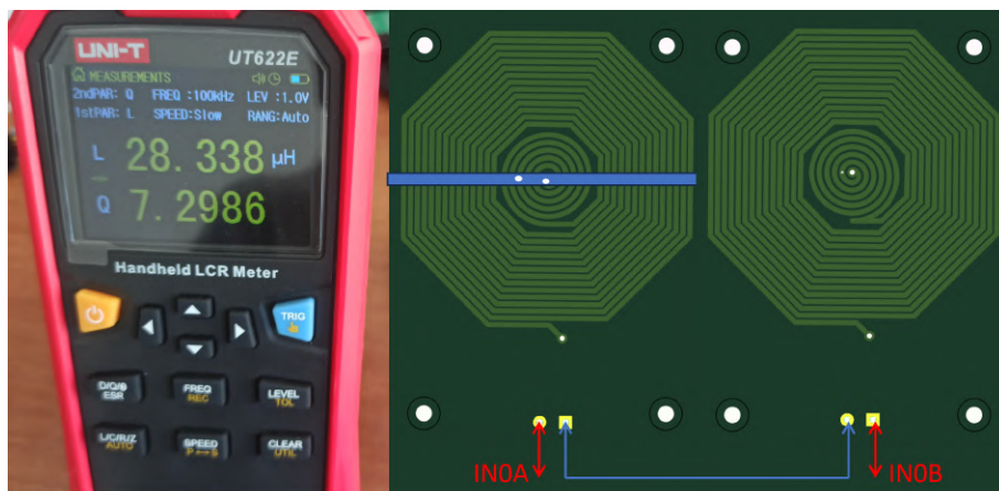
Şekil 3.44. İç içe bobin ve ters iç içe bobinin karşılıklı bağlanarak LCR metre ile test edilmesi
