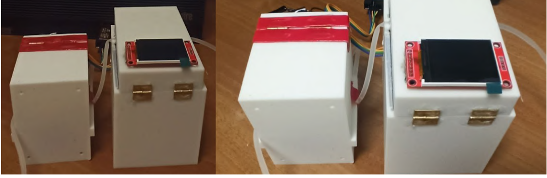
Şekil 3.45. Sistem bileşenlerinin entegre edilmiş nihai cihaz prototipi
