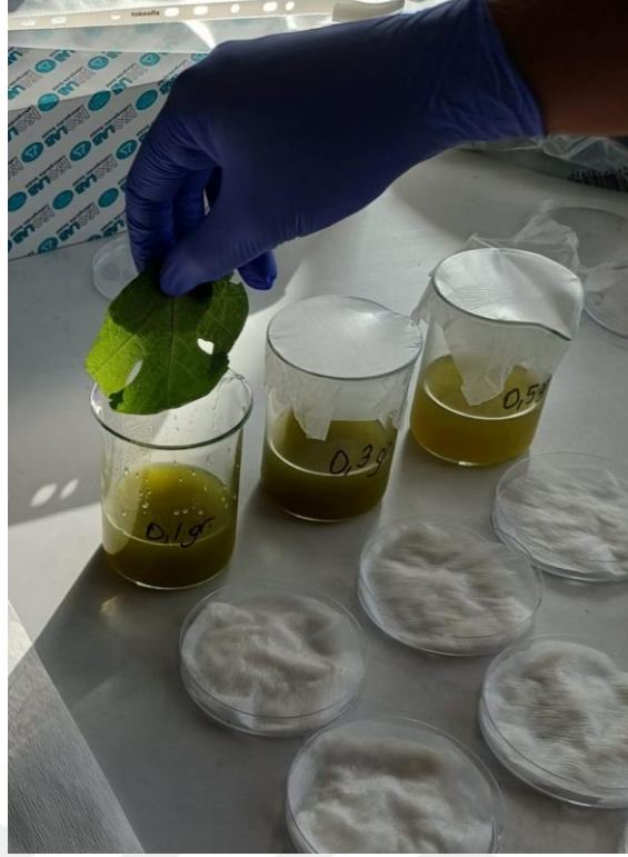
Şekil 3.8. Yapraklara daldırma yönteminin uygulanması
