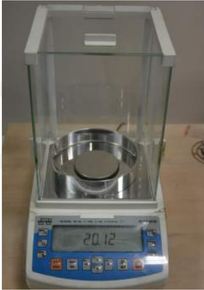
Şekil 3.3. Tozların tartılması için kullanılan RADWAG marka hassas terazi.
