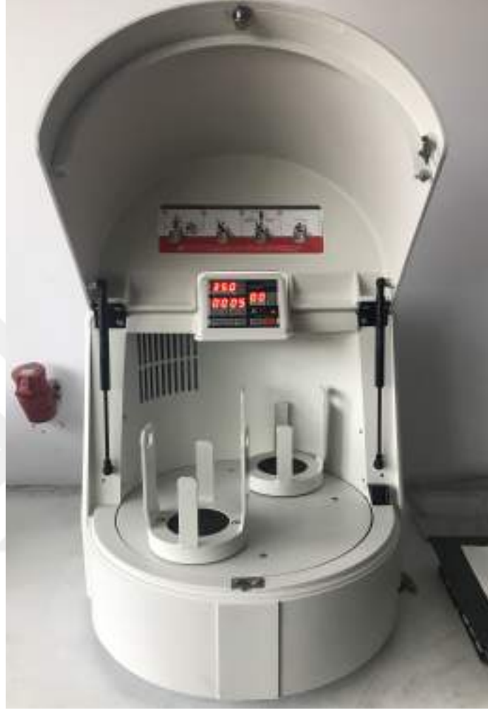
Şekil 3.4. Tozların karıştırılmasında kullanılan FRITSCH marka gezegen tipi karıştırıcı.
