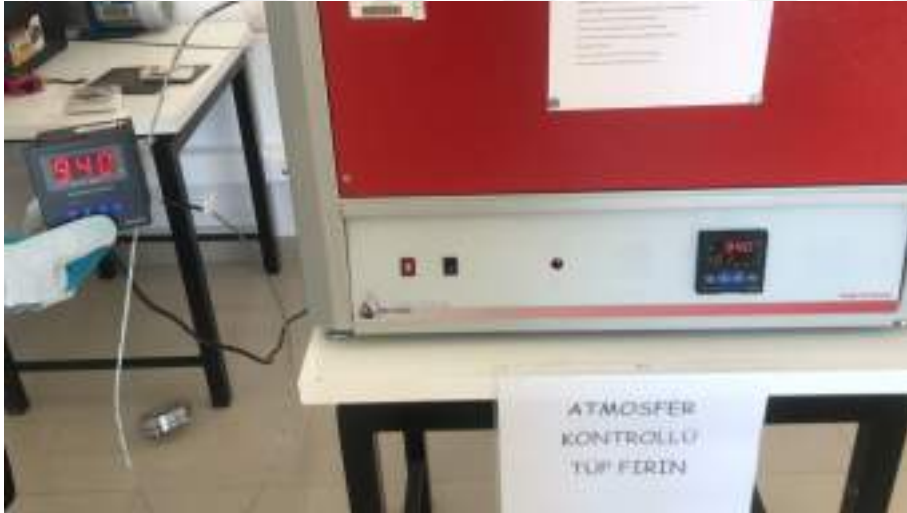
Şekil 3.10. Atmosfer kontrollü tüp fırının ısınma doğruluğunu gösteren ölçüm.
