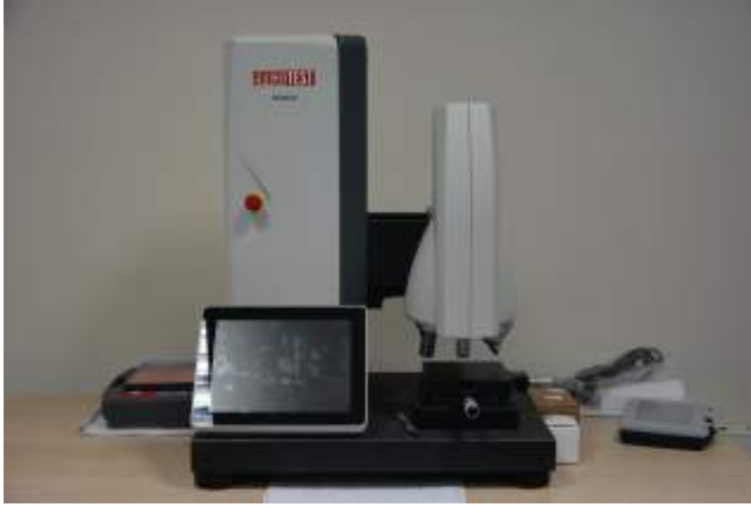
Şekil 3.12. EmcoTest DuraScan otomatik sertlik ölçüm cihazı.
