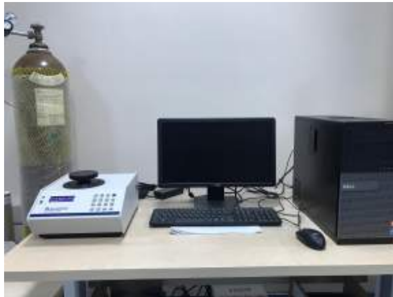
Şekil 3.11. Yoğunluk ölçümlerinin gerçekleştirildiği micromeritics marka piknometre cihazı.
