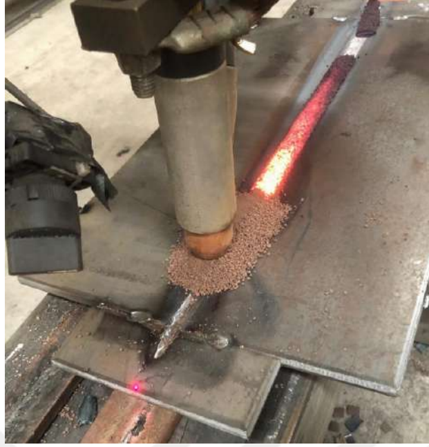
Şekil 7.2. SG2 kaynak tozu ile kaynatılan numune
