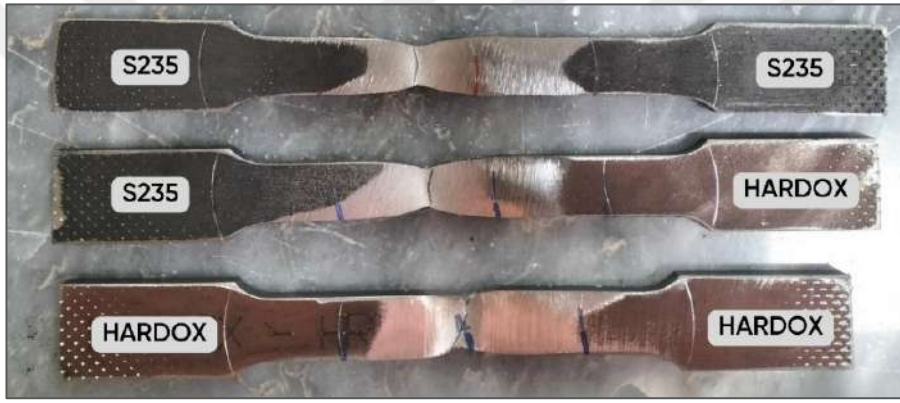
Şekil 8.7. Birleştirme kırılma makrografı
