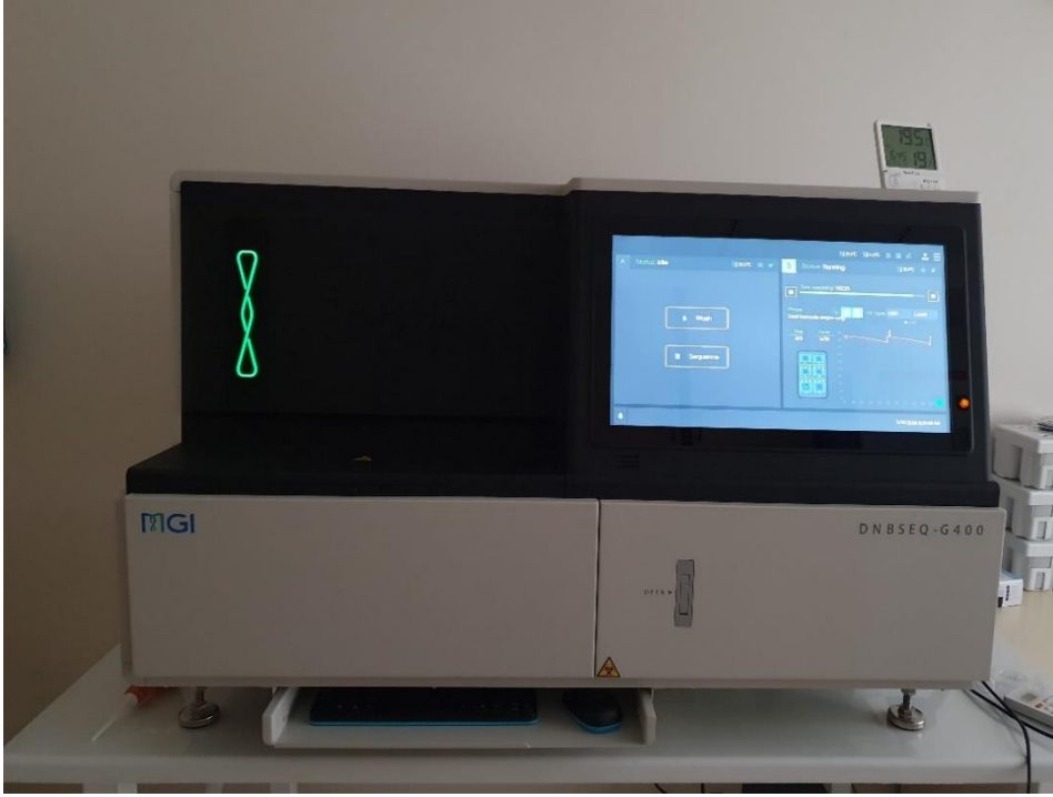
Şekil 3.6: DNA dizilemesi için kullanılan, numunelerin yüklendiği sekanslama cihazı (MGI DNBSEQ G400RS).
