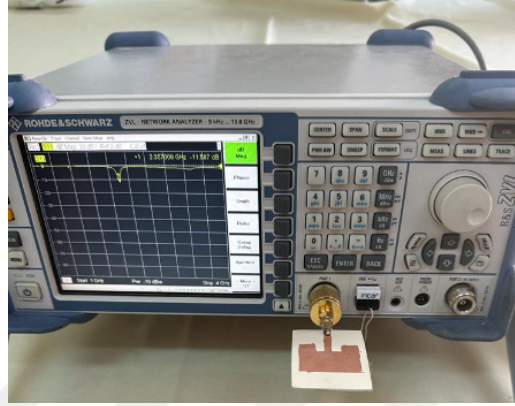
Şekil 3.2. Rogers3006 Alt Tabakalı MYA Ölçümü ( S_{11} değişimi)
