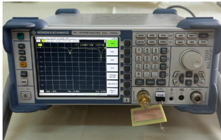
Şekil 3.1. FR4 Alt Tabakalı MYA Ölçümü ( S_{11} değişimi)
