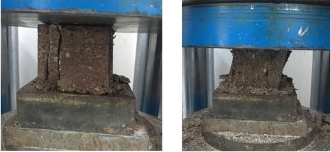
Şekil 3.7. Asit karışımları ortamında 6'şar ay bekletilen Sille taşının basınç deneyi görselleri
