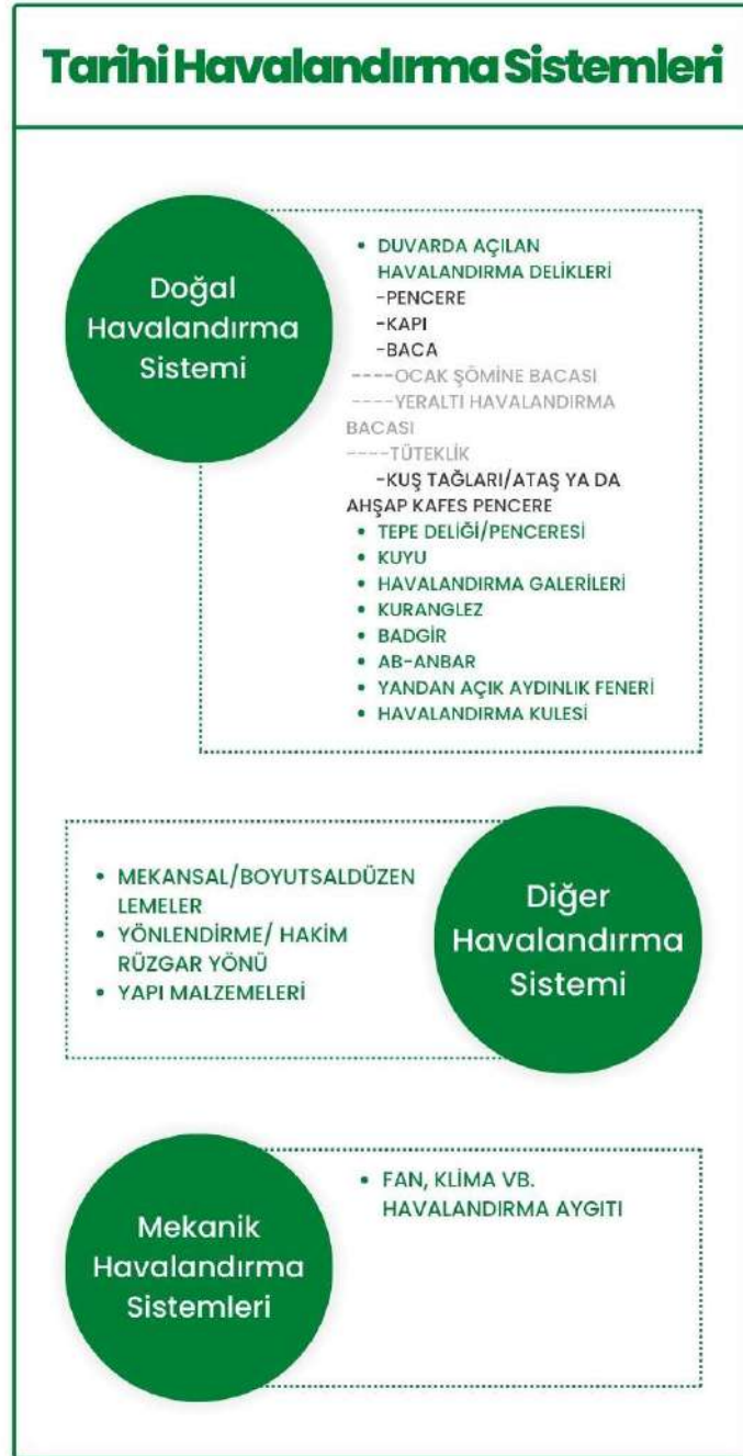
Şekil 3.16. Tarihte kullanılan başlıca havalandırma elemanları (Yazar tarafından yapılmıştır.)
