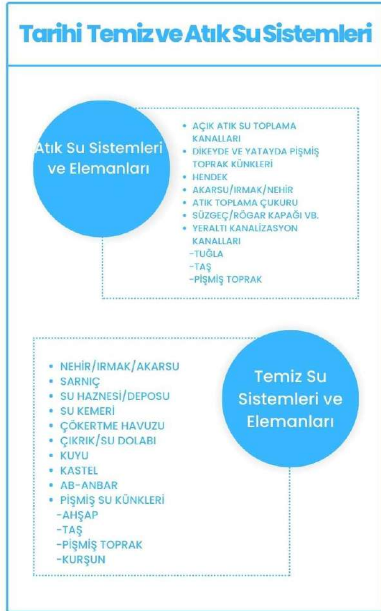
Şekil 3.19. Tarihte kullanılan başlıca temiz ve atık su elemanları (Yazar tarafından yapılmıştır.)
