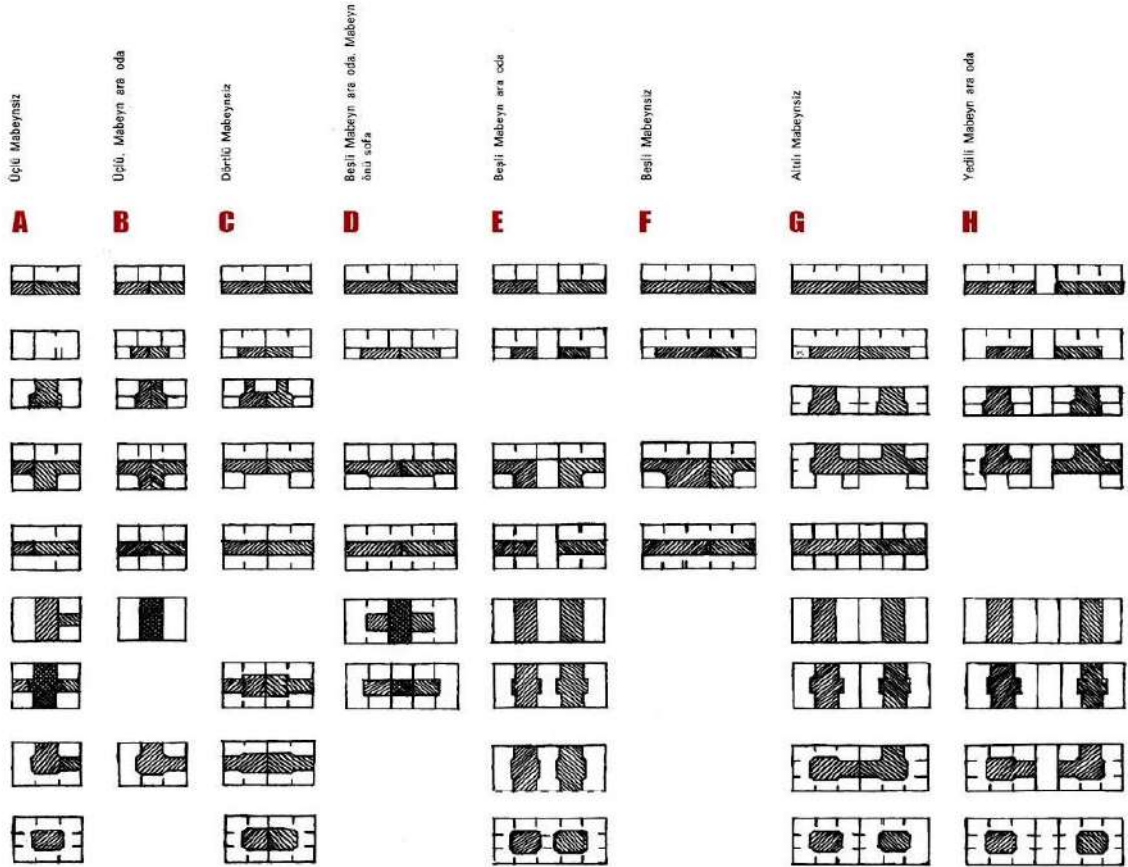
Şekil 3.7. Türk evi bölümlerinin farklı şematik gösterimleri (Eldem, 1955)
