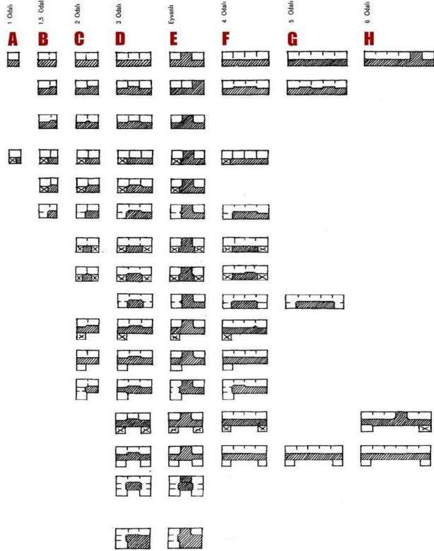
Şekil 3.4. Türk evi dış sofalı planı şematik gösterim (Eldem, 1955)
