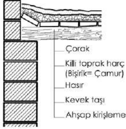
Şekil 3.20. Toprak dam katmanları (Büyükmihçi, 2015).
