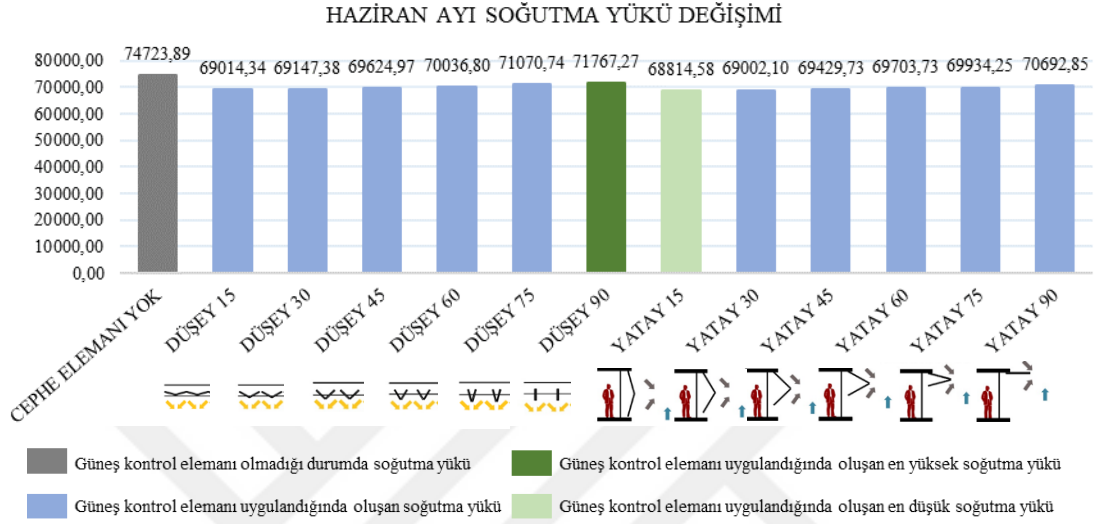
Şekil 5.9. Haziran ayı soğutma yüklerinin güneş kontrol elemanının konumuna göre değişimi
