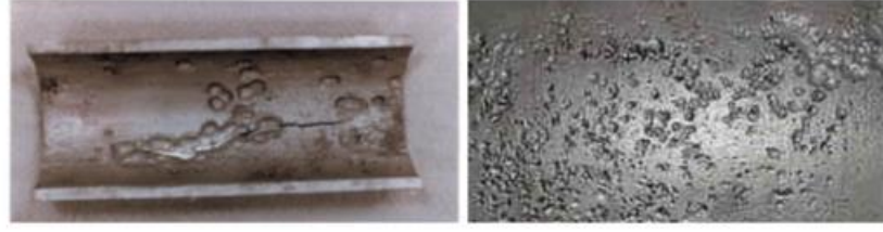
Şekil 3.2. Çukurcuk korozyon örnekleri
