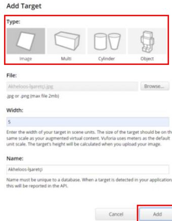
Şekil 3.4. Vuforia veri tabanı ve marker (işaretçi) oluşturulması.
