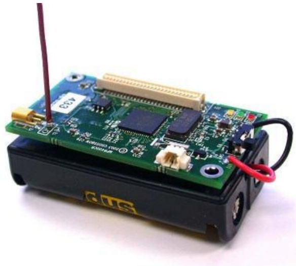
Şekil 1.11 Crossbow firması tarafından üretilen MicaZ algılayıcı düğümü (Soy, 2013)
