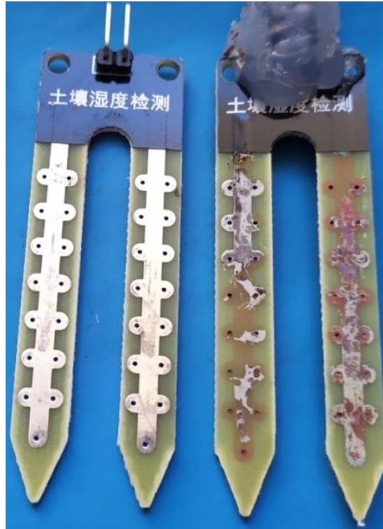
Şekil 2.24 Algılayıcı çubuğun aşınması
