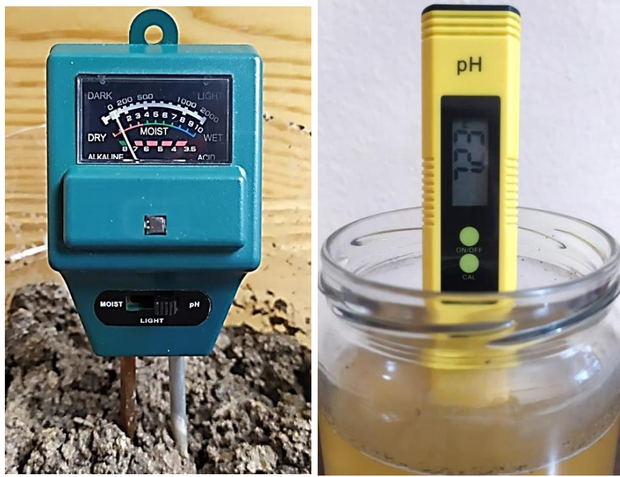
Şekil 2.21 TN-200 ve PH-200 ile sera toprağının pH ölçümleri
