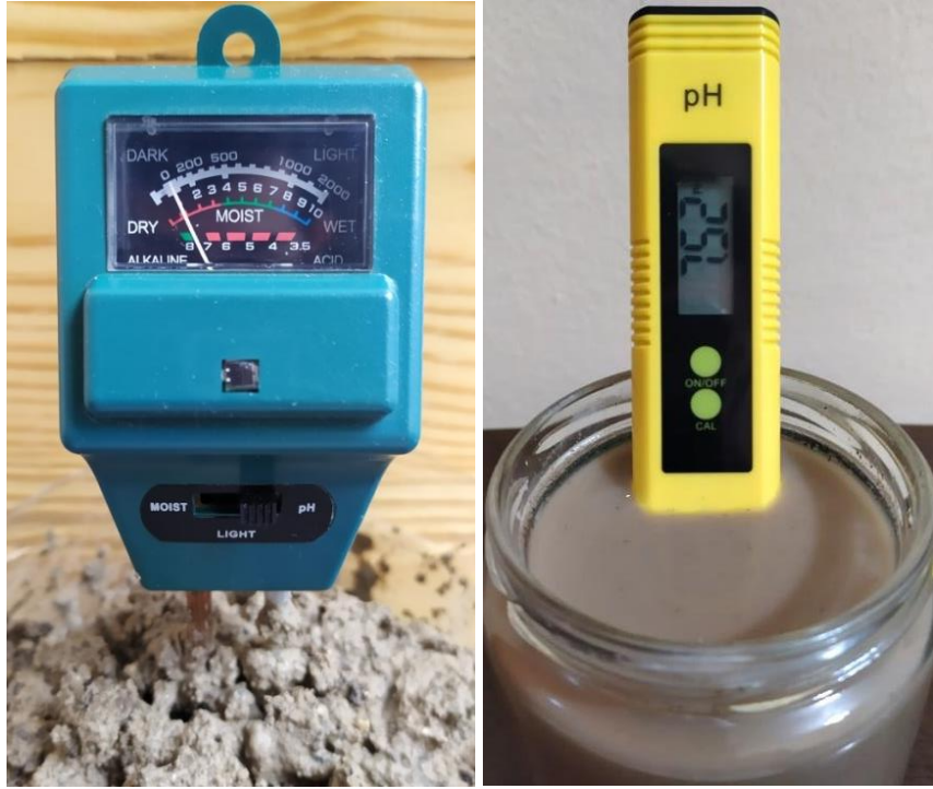
Şekil 2.19 TN-200 ve PH-200 ile bölge toprağının pH ölçümleri
