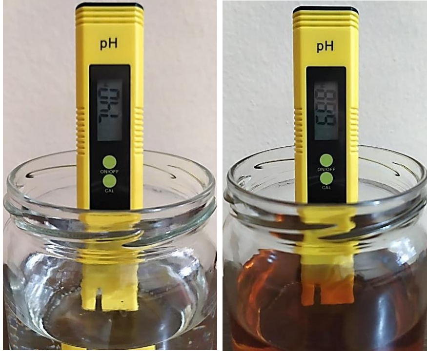
Şekil 2.22 PH-200 ile şebeke suyu ve sulama suyunun pH ölçümleri
