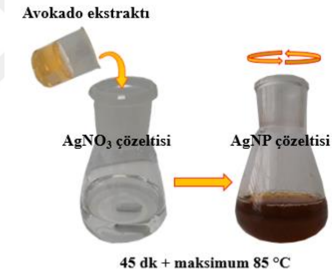
Şekil 3.5. Gümüş nanopartikülün geleneksel metotla yeşil sentezi.
