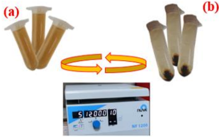
Şekil 3.6. (a) Santrifüj edilmeden önceki görünümü, (b) santrifüj işlemi sonrası nanopartiküllerin görünümü.
