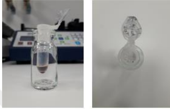
Şekil 3.12. Altın nanopartikül içeren toz numune tüpü örneği.
