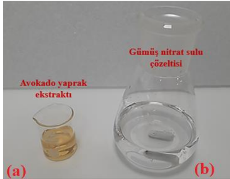
Şekil 3.4. (a) (2 mg/mL) ekstrakt-su çözeltisi, (b) \text{AgNO}_3 çözeltisi.
