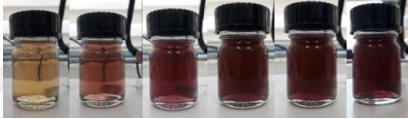
Şekil 4.2. Altın nanopartikül sentezinin renk değişimi
