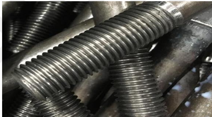
Şekil 3.1. Ovalama ile diş açılmış malzeme
