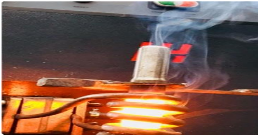
Şekil 2.5. İndüksiyon ile malzeme ısıtma
