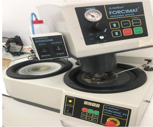
Şekil 3.6. Metkon marka zımparalama ve parlatma makinesi
