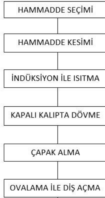
Şekil 2.1. Sıcak dövme cıvata üretim aşamaları
