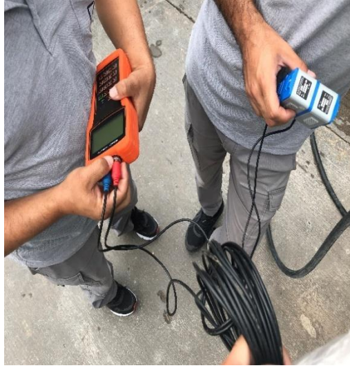
Şekil 4.10. Portatif ultrasonik debimetre cihazı ve sensörleri (KOSKİ, 2021)
