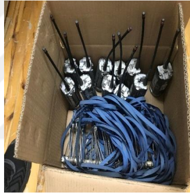
b) Sensörlerin bağlanacağı kancalı ip
