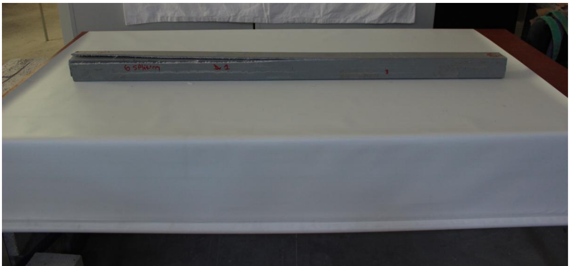
Şekil 3.35. Orta noktası boşluklu beton ile doldurulmuş GFRP malzemenin eğilme sonrası davranışı
