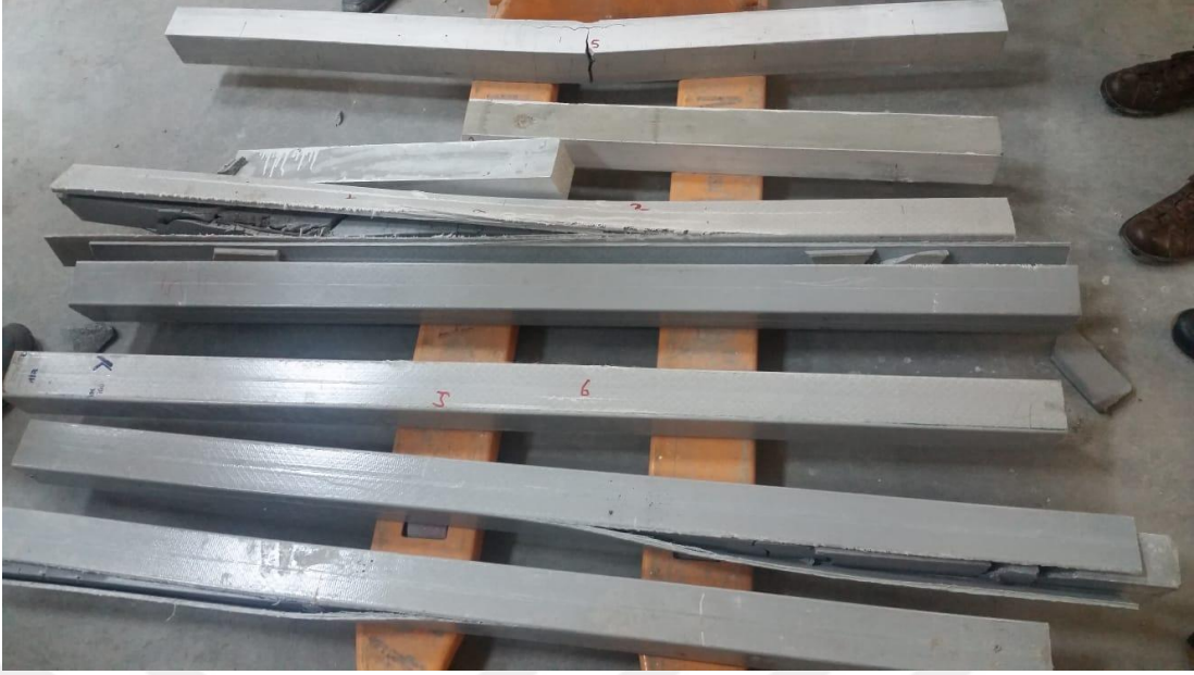
Şekil 4.2. Eğilme deneyi sonrasındaki GFRP ve beton numuneler
