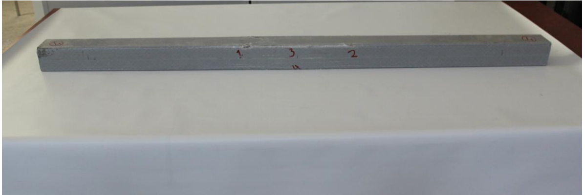
Şekil 3.27. Yarı beton ile doldurulmuş GFRP profil malzemede eğilme sonrası oluşan hasarlar
