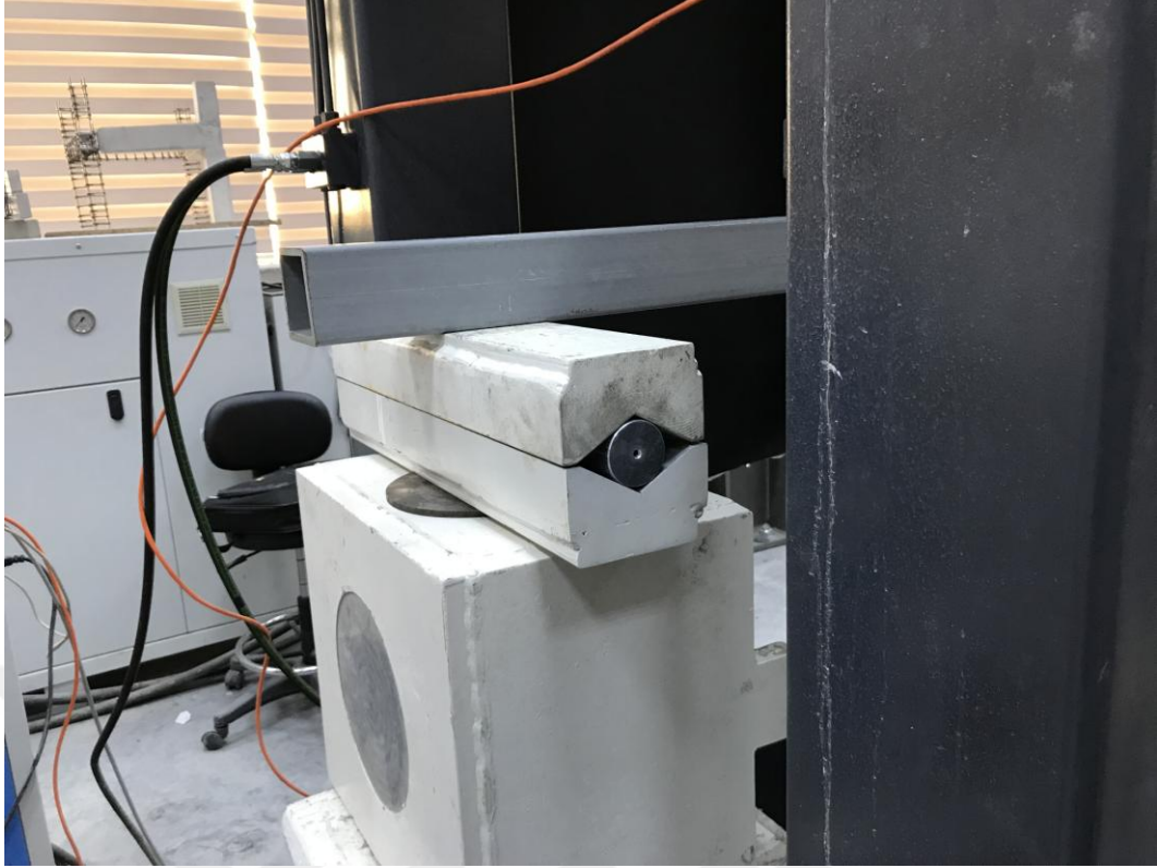
Şekil 3.9. Eğilme deney düzeneğinde sabit mesnet
