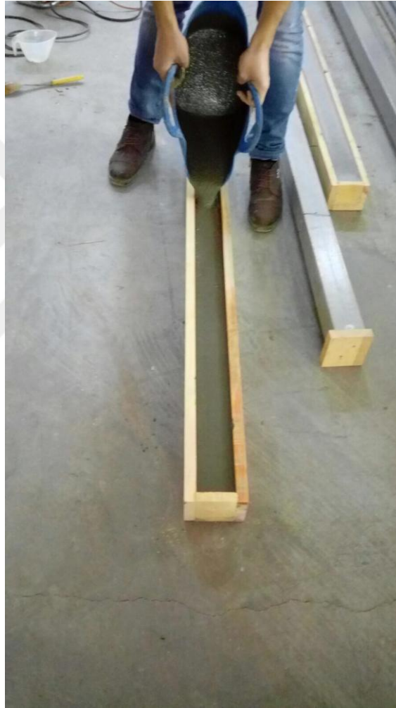
Şekil 3.46. Betonun ahşap kalıba dökülmesi
