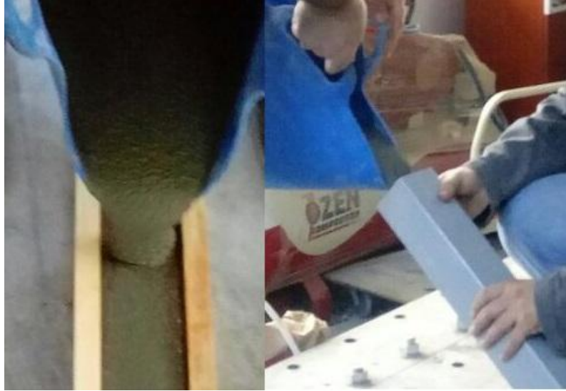
Şekil 3.1. Laboratuvar ortamında beton karışımının hazırlanması
