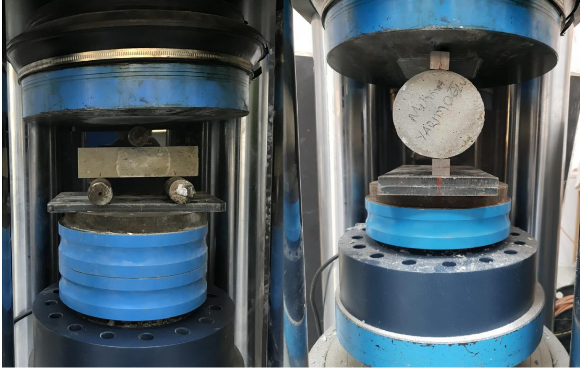
Şekil 3.6. Eğilme çekme ve yarmada çekme dayanım testi
