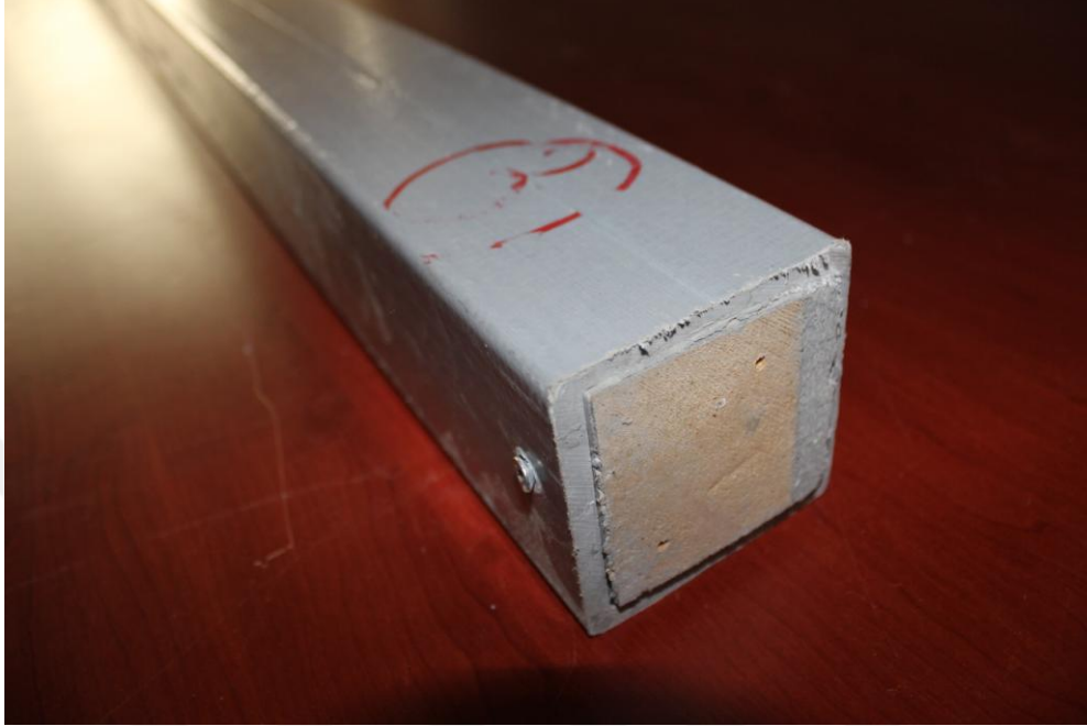
Şekil 3.21. GFRP malzemenin uç kısımların ahşap malzeme ile kapatılması
