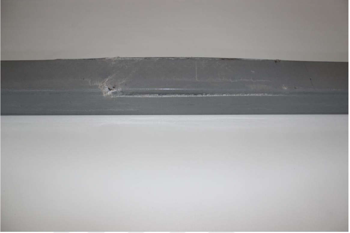
Şekil 3.14. Üst bölgeden yırtılan içerisi boş GFRP numune
