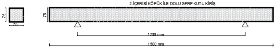
Şekil 3.17. İçerisi köpük ile sıkıştırılmış GFRP malzeme şeması
