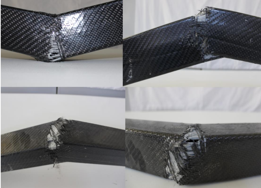
Şekil 3.40. Dış karbon elyaf ile sarılmış içerisi betonla doldurulmuş GFRP malzemenin eğilme sonrası davranışı
