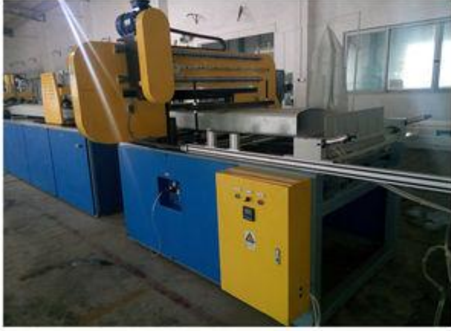
Şekil 2.3. Pultruzyon makinesi örneği (Anonim 2018f)
