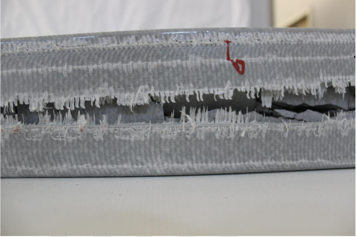
Şekil 3.44. İçerisi donatılı betonla doldurulmuş GFRP malzemenin eğilme sonrası davranışı
