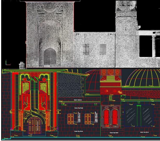
Şekil 7. Ön Cephenin Nokta Bulutundan Çiziminin Elde Edilmesi
