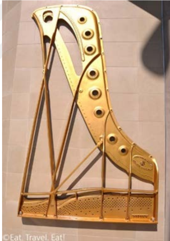
Şekil 2.10 Kuyruklu piyanonun döküm iskeleti
