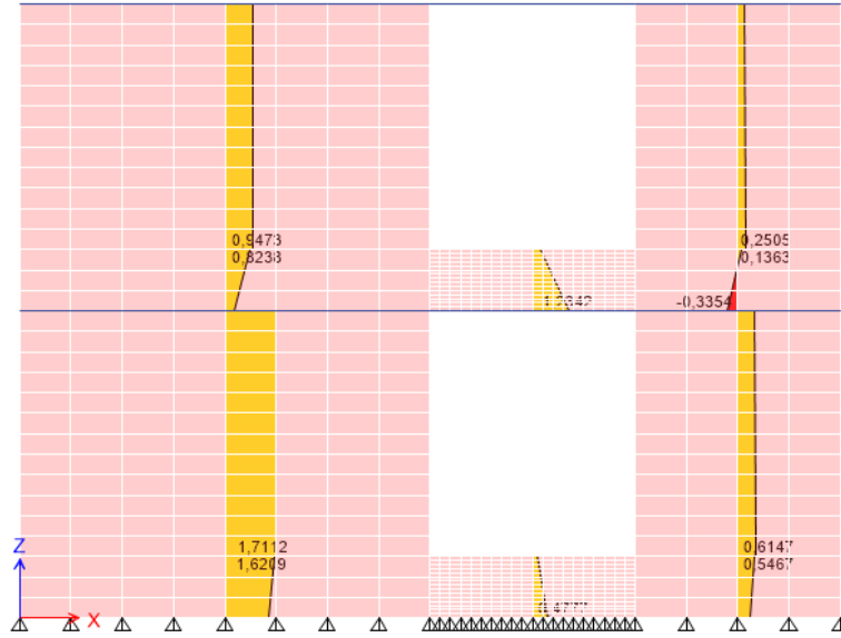
Şekil 3.4.3: EX kuvveti altında (1) 1 aksı duvarlarında oluşan kesme kuvveti diyagramı, (2) 2 aksı duvarlarında oluşan kesme kuvveti diyagramı.
