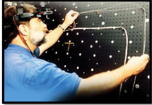
Şekil-13. Kablo Tesisatları Montajı Uygulaması
