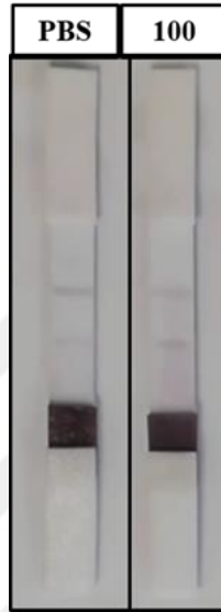
Şekil 4.38. Yıkanmış membran, yıkanmış cam elyaf kullanılarak elde edilen LFA'larda 100 ng/mL BH ve PBS çözeltilerinin yürütülmesi sonucu elde edilen test ve kontrol çizgileri
