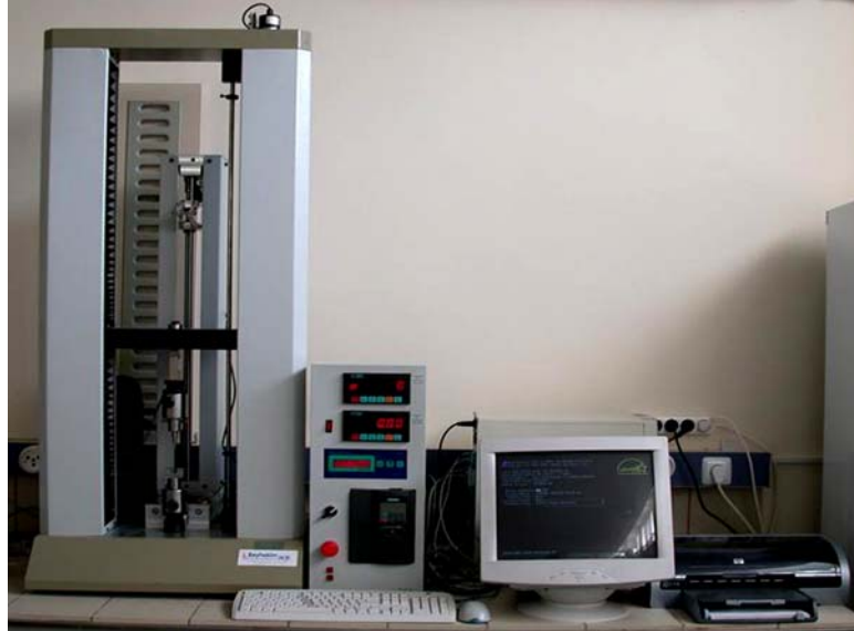
Resim 3.9 : TEDEA Huntleigh Model No:615 çekme-basma test cihazı.
