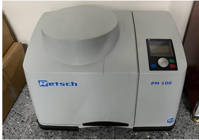
řekil 3.6. alıřmada Kullanılan Retsch PM100 Bilyeli Deęirmen
