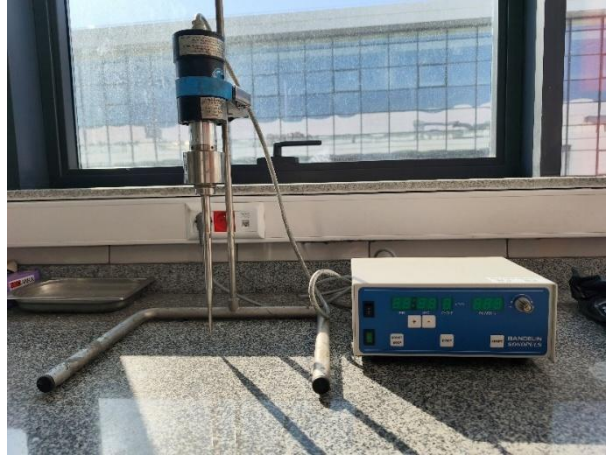
Şekil 3.2. Bandelin Sonopuls HD 2200 ultrasonik homojenizatör.
