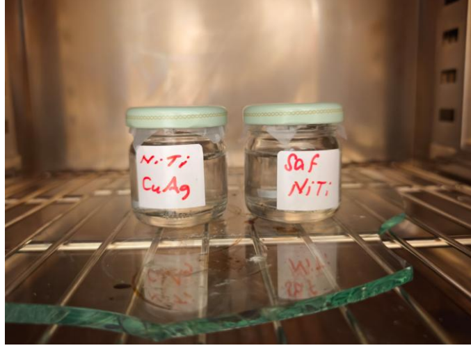
Şekil 3.23. PCL+Kolajen nanofiber kaplı NiTi ve NiTiCuAg numunelerin biyobozunurluk testleri.
