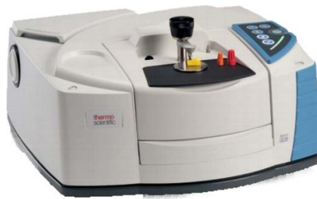
Şekil 3.21. Nicolet IS20 FTIR test cihazı (“BİTAM - Bilim ve Teknoloji Araştırma Uygulama Merkezi”, t.y.).
