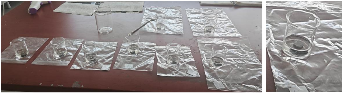
Şekil 3.17. Silan tabakası oluşturmak için uygulanan çözelti ve disk numuneler.
