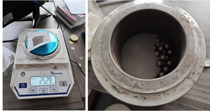
Şekil 3.5. Nanopartikül – etanol solüsyonu ilavesi öncesi NiTi tozları ve WC bilyeler (10mm)
