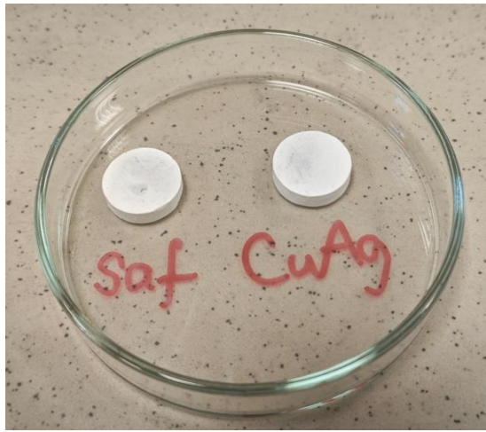
Şekil 3.22. Şişme testi öncesi NiTi ve NiTiCuAg kuru numuneler.
