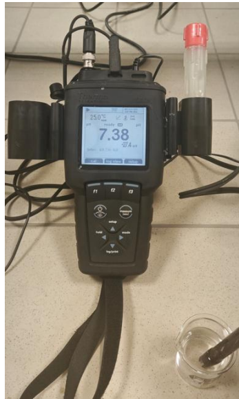
Şekil 3.24. Test öncesi PBS çözeltisi PH ölçümü.
