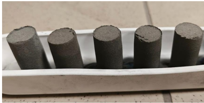
Şekil 3.9. Sıkıştırılmış basma numunelerinin sinterleme öncesi durumu.
