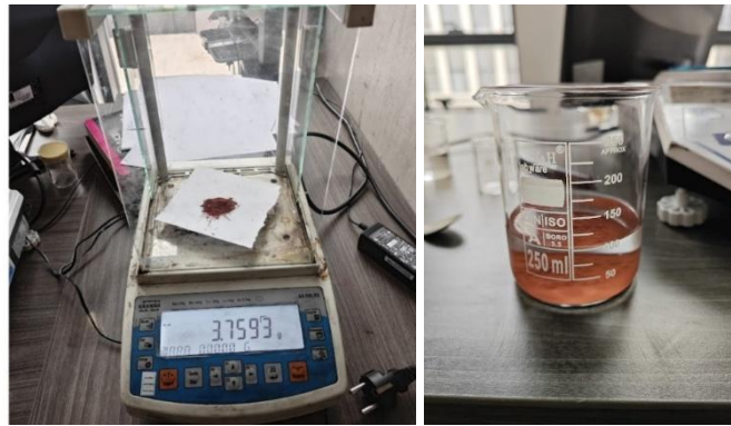
Şekil 3.3. %2,5 Cu İlavesi İçin Nano Tozların Hazırlanması
