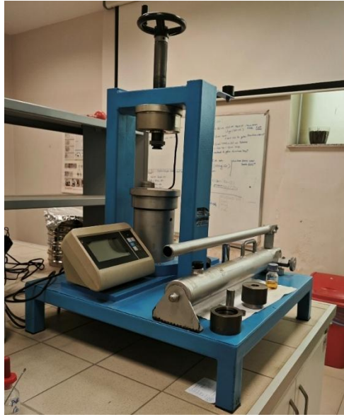
Şekil 3.10. 20 ton kapasiteli load-cell entegreli hidrolik pres.
