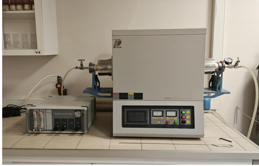
Şekil 3.11. Atmosfer kontrollü 1700°C kapasiteli tüp fırın.
