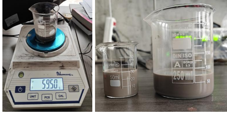
Şekil 3.4. Etanol içerisinde dağıtmak üzere hazırlanan Ag ve Cu içeren çözeltiler
