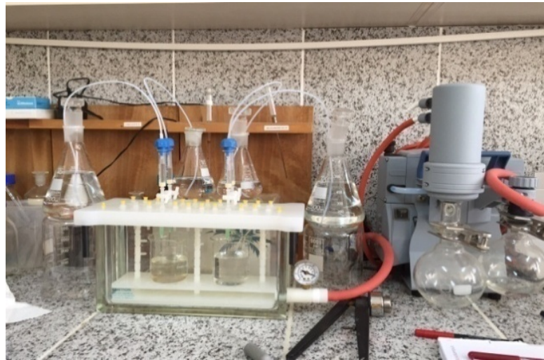
Şekil 3.4. SPE düzeneği (J.T. Baker)
