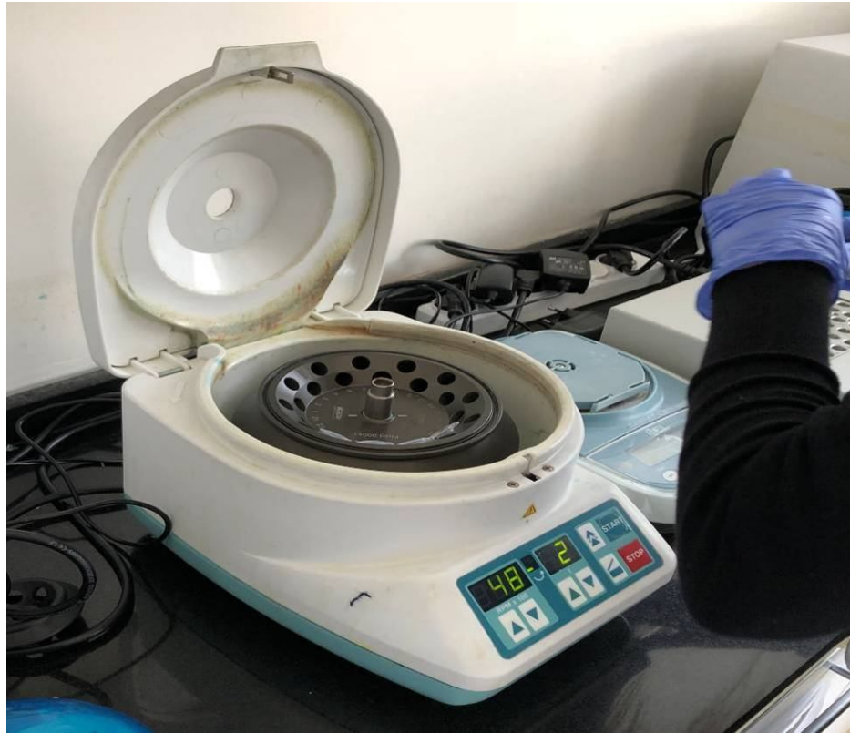
Şekil 3.12. Numunelerin santrifüj cihazına yerleştirilmesi.
