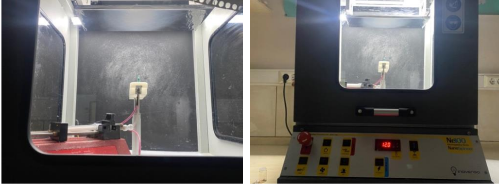
Şekil 3.3. Elektroğirme cihazı ile nanofiber üretimi.
