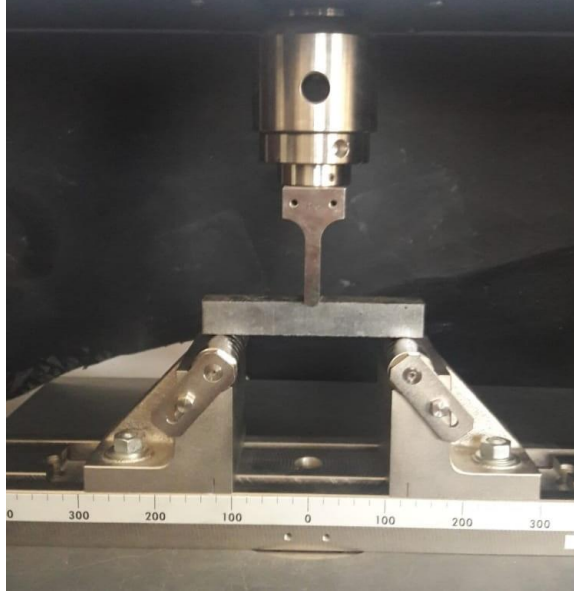
Şekil 3.6. Çubuk Numunenin Eğme Test Görüntüsü
