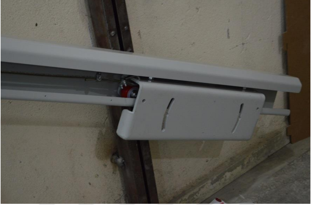
Şekil 5.4 Rayın İçerisindeki Arabanın Görünümü
