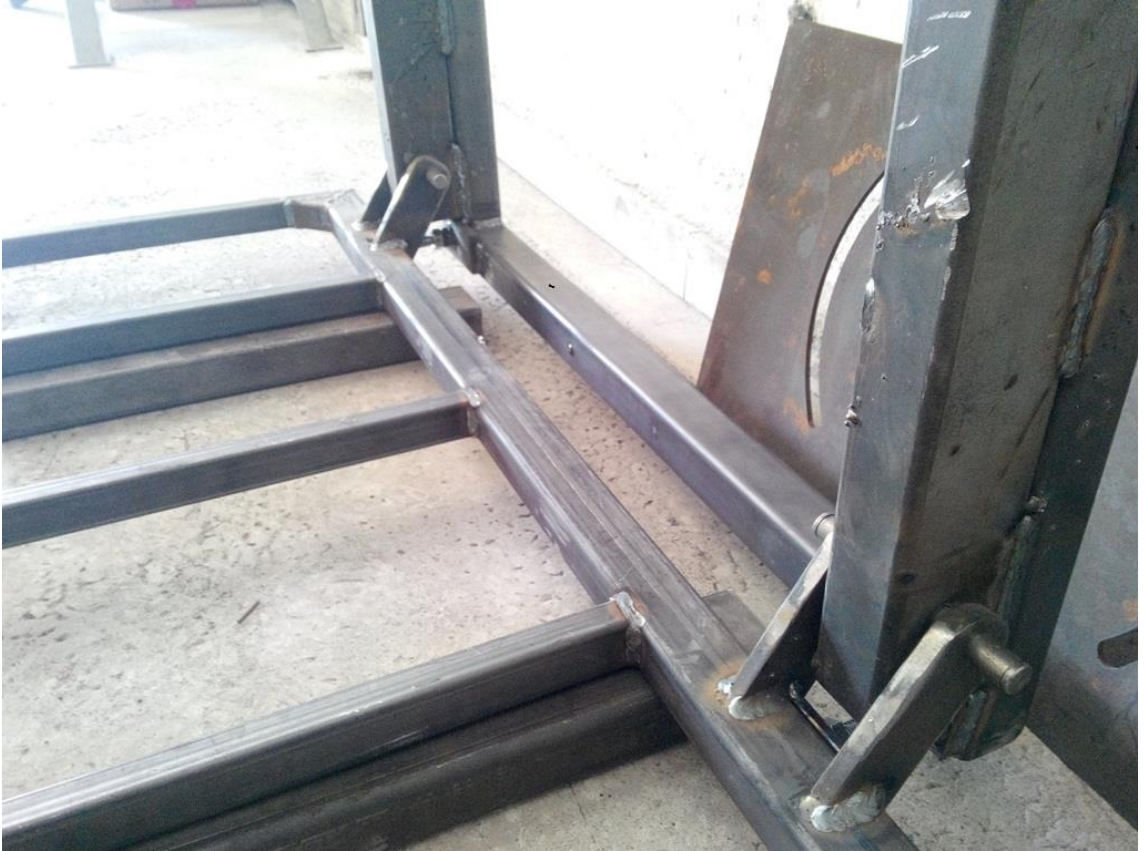
Şekil 5.1 Katlanır Platformun Menteşe Sistemi
