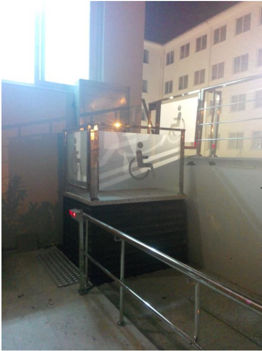
Şekil 1.3 Dikey Tip Engelli Platformu
