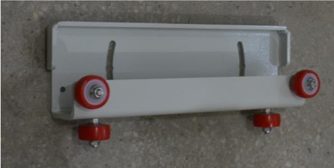
Şekil 5.3 Raydaki Hareketi Sağlayan Arabanın Montajlanmış Alt Montaj Grubu
