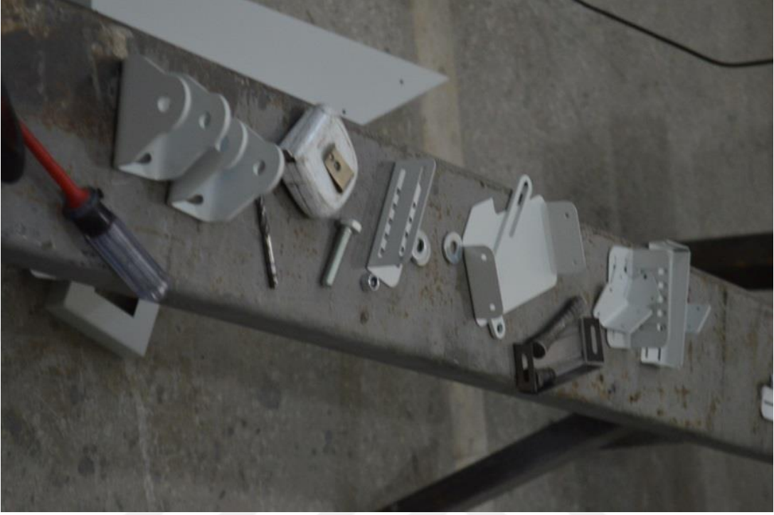
Şekil 5.2 Lazer kesim abkant bükümden sonra statik boya görmüş parçalar
