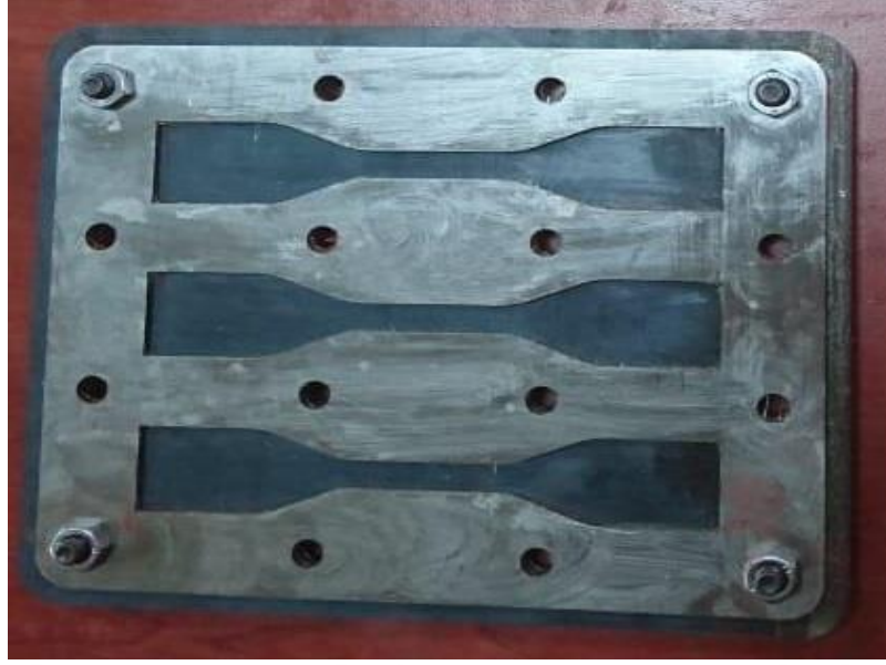
Şekil 4.16. Deney numunesi üretilecek krom nikel kalıplar
