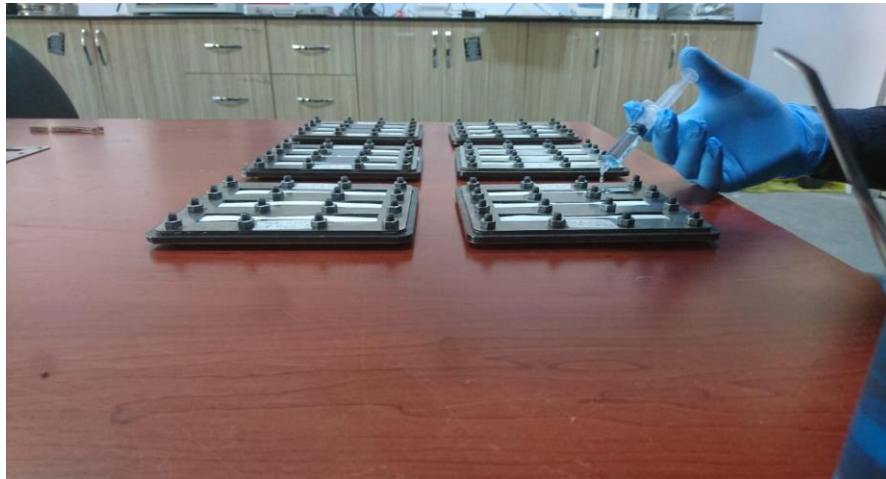
Şekil 4.19. Kalıba yerleştirilmiş PVA nanoelyaflara epoksi reçine ilavesi
