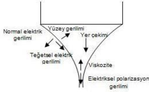
Şekil 3.3. Taylor konisinin oluşumuna etki eden kuvvetlerin şematik gösterimi.
