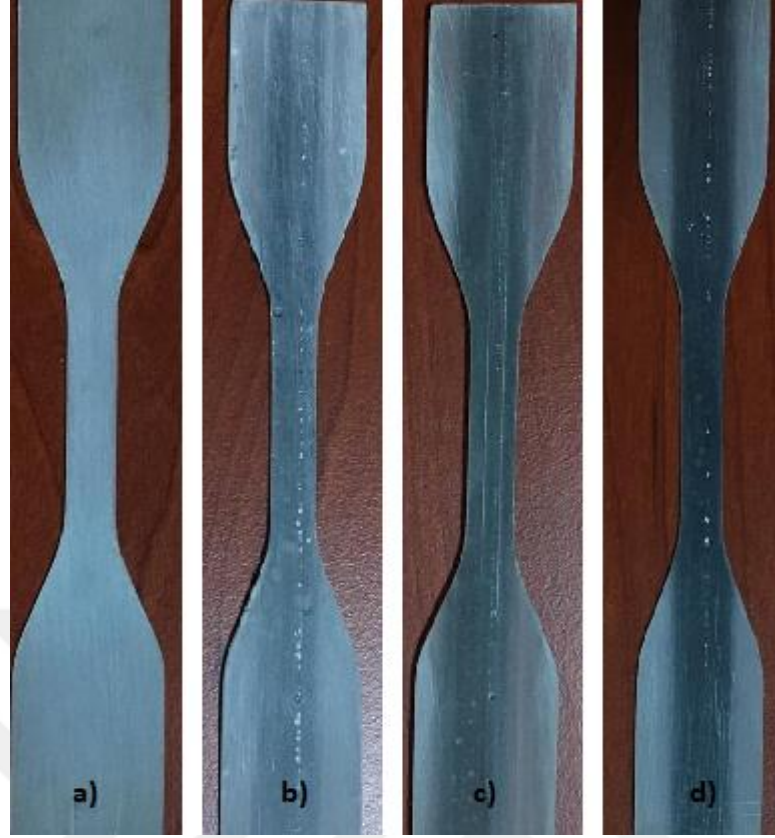
Şekil 5.17. Ağırlıkça % 5 ÇCKNT ile güçlendirilmiş PVA nanoelyaf takviyeli kompozitlerin çekme deneyi öncesi görünümleri; a) Epoksi, b) 5KNT5, c) 5KNT10, d) 5KNT15
