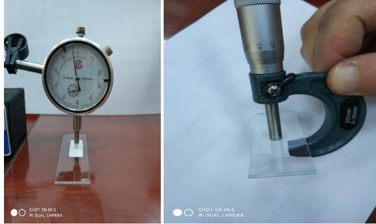
Şekil 4.10. Elektro eğirme yöntemi ile üretilmiş nanoelyafların ortalama kalınlıklarının ölçümü
