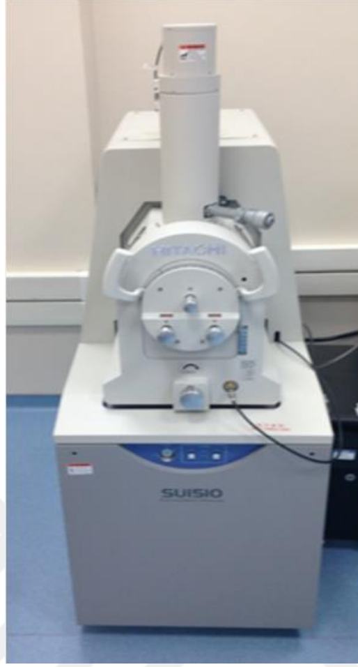
Şekil 4.4. Taramalı elektron mikroskobu (SEM)
