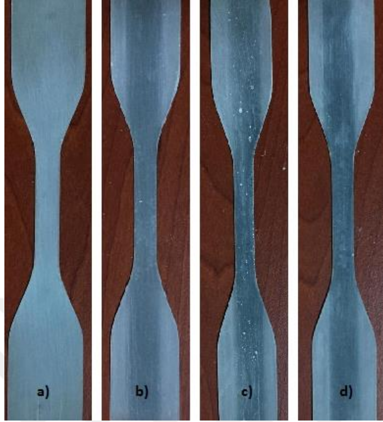
Şekil 5.15. Ağırlıkça % 3 ÇCKNT ile güçlendirilmiş PVA nanoelyaf takviyeli kompozit malzemelerin çekme deneyi öncesi görüntüleri; a) Epoksi, b) 3KNT5, c) 3KNT10, d) 3KNT15
