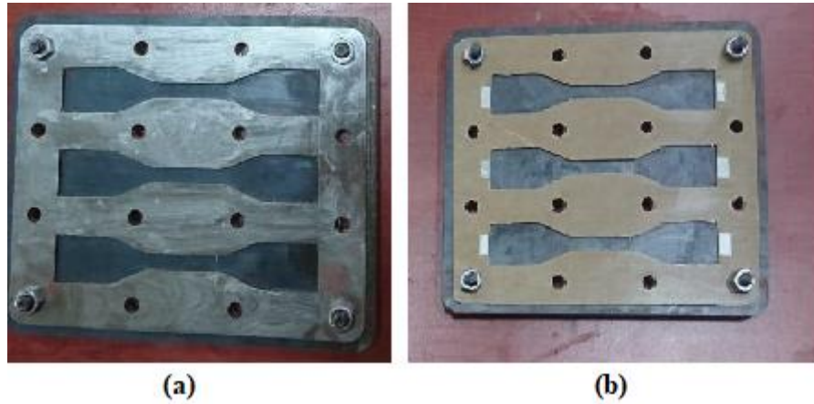
Şekil 4.17. Deney numunesi üretimi yapılacak kalıplar (a) Kalıp ayırıcı sürülmüş kalıp, (b) Politetrafloroetilen film yapıştırılmış kalıp
