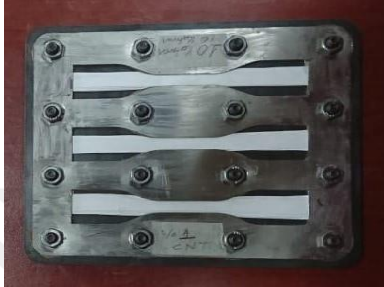
Şekil 4.18. Kalıba yerleştirilmiş nanoelyafların görünümü
