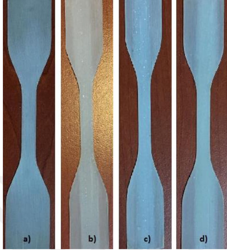
Şekil 5.11. PVA nanoelyaf takviyeli kompozit malzemelerin çekme deneyi öncesi görünüşleri; a) Epoksi, b) P5, c) P10, d) P15
