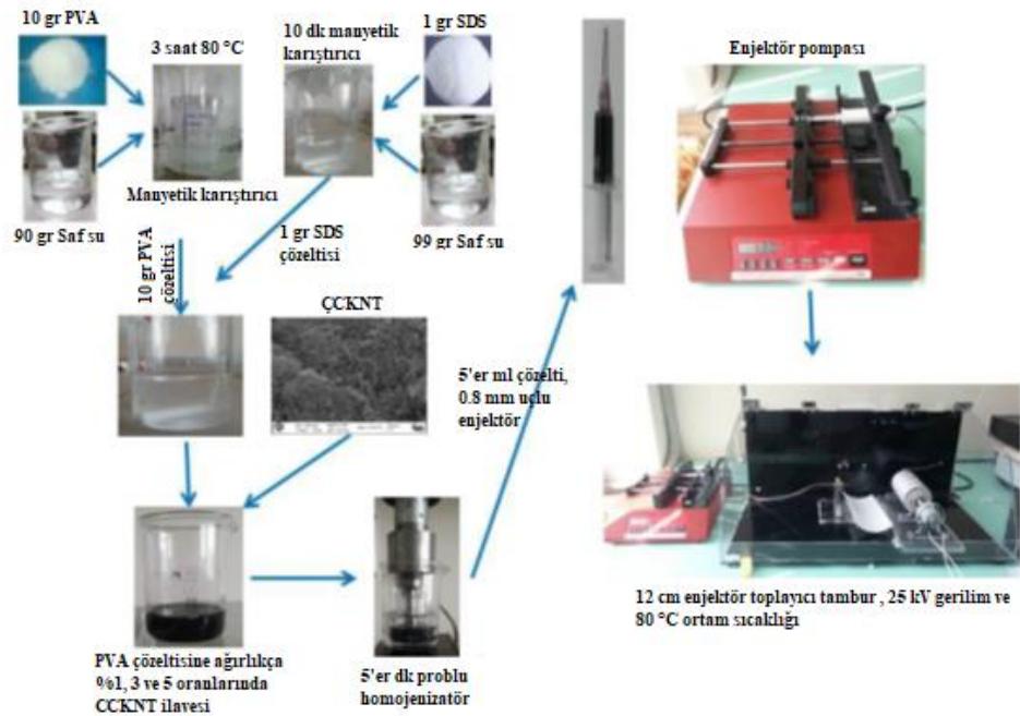
Şekil 4.12. Elektro eğirme yöntemiyle farklı oranlardaki ÇCKNT ile güçlendirilmiş PVA nanoelyaf üretim basamakları (Ekrem, 2015)
