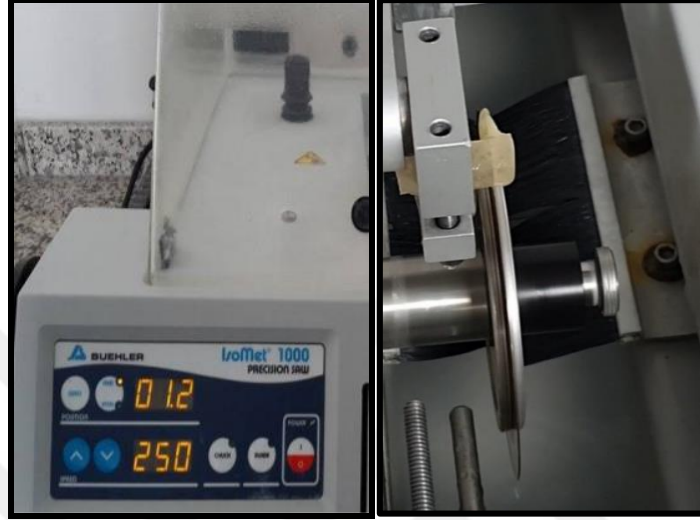
Şekil 8: İsoMet Cihazı (Isomet, Buehler, Lake Bluff, IL, ABD)
