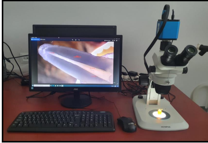
Şekil 10: Örneklerin stereomikroskoba (Olympus SZ61, Tokyo, Japonya) bağlanan bir dijital kamera (Toupcam 1080PHD, ToupTek, Çin) ile bilgisayara aktarılıp, incelenmesi.
