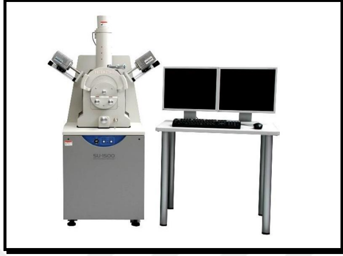
Şekil 13: SEM cihazı (Hitachi-SU 1510, Tokyo, Japonya)
