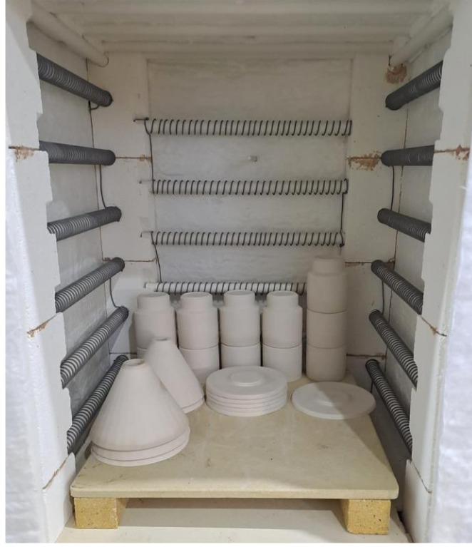
Şekil 86. Rötüş Sonrası Dökümleri Fırına Yerleştirme
