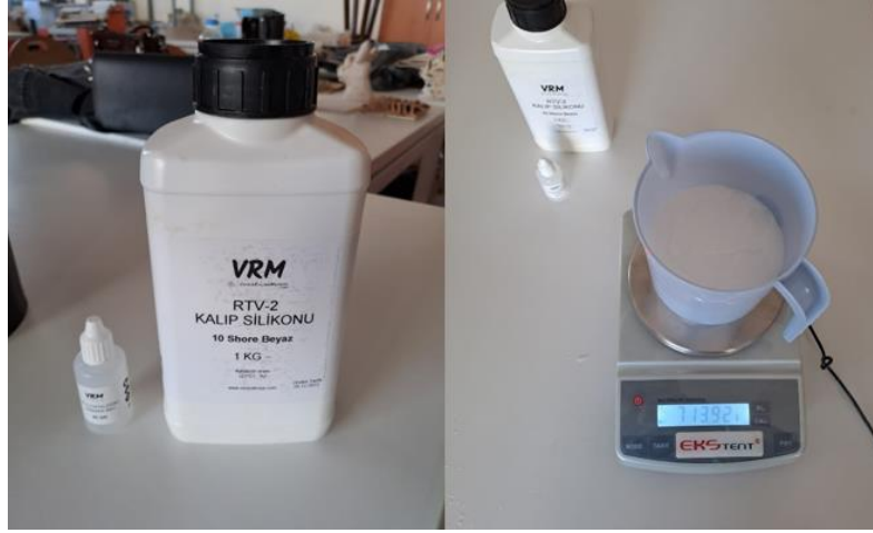
Şekil 75. Silikon ve Katalizörün Hazırlanması
