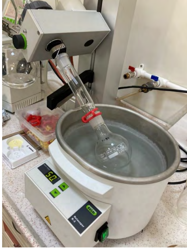
Şekil 3.51: Evaporatörde hacim azaltma
