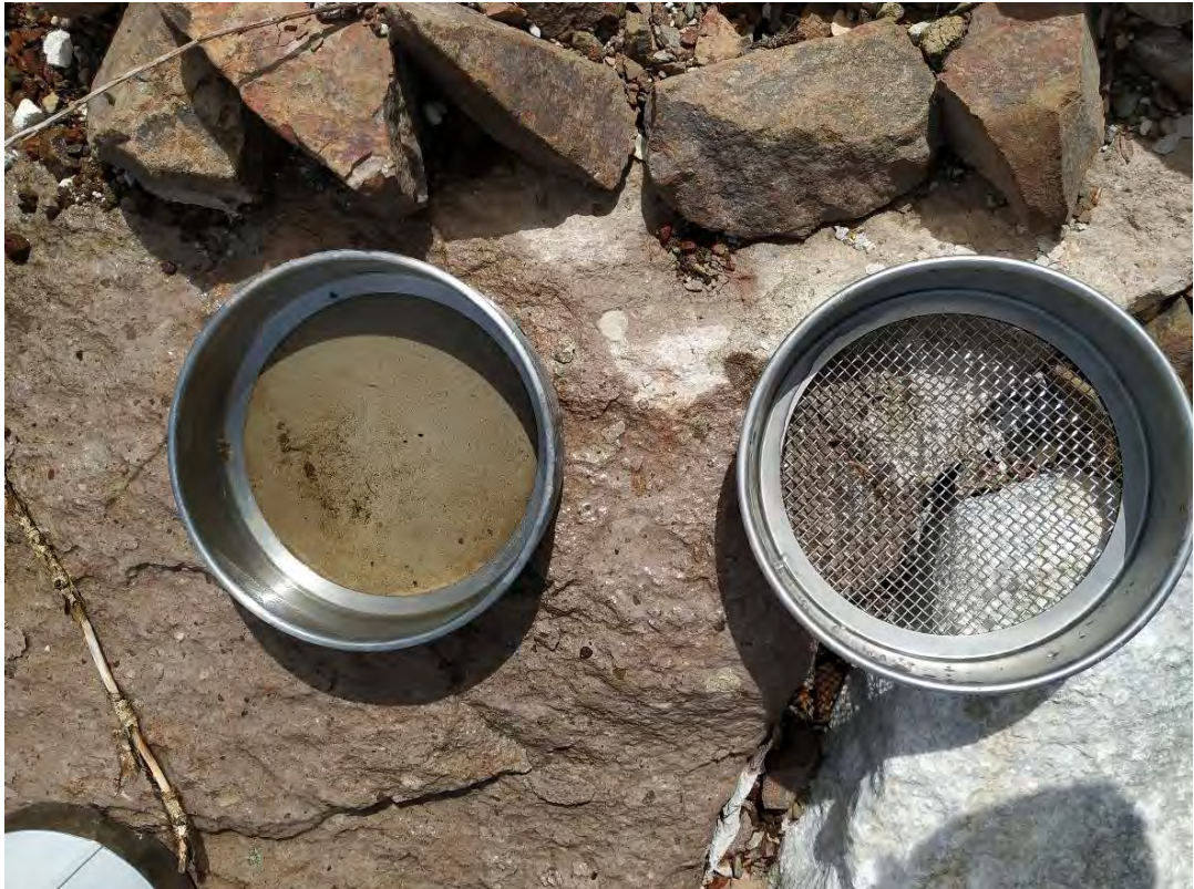
Şekil 3.35: Numune süzme işlemi sırasında kullanılan 5 mm ve 20 µm'lik çelik elekler
