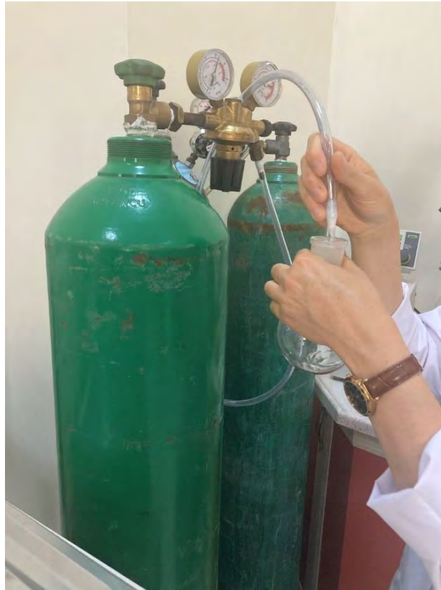
Şekil 3.52: Azot gazıyla hacim azaltma
