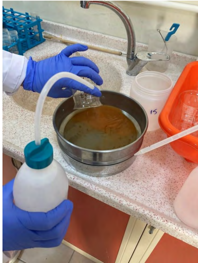
Şekil 3.41: Yoğunluk ayırımı işlemi sonrasında süzülen numuneler
