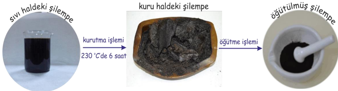
Şekil 3.2. Sıvı haldeki şilempeye uygulanan ön işlemler.
