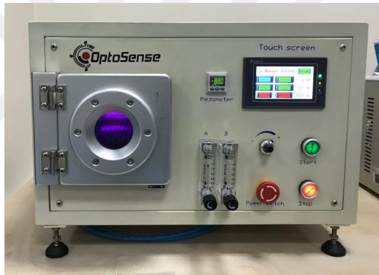
Şekil 3.5. Oksijen plazma uygulamasının gerçekleştirildiği plazma reaktörü (Optosense, OPT-PCO-02).
