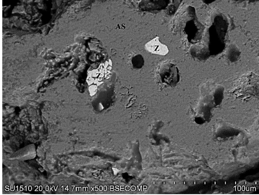
Şekil 4. 50. Oksijen atmosferinde korozyon testi yapılan %10 1050 HDAK kodlu şamot refrakter malzemesinin refraktere yakın 3. bölgenin geri yansıyan elektron görüntüsü (500×)
