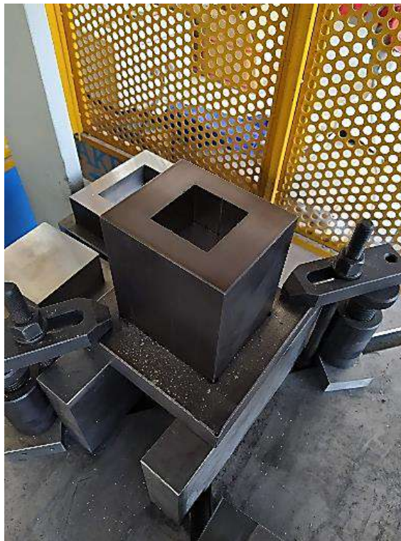
Şekil 3. 1. Şekillendirmede kullanılan 125 cm 3 kare prizma kalıba ait görüntü
