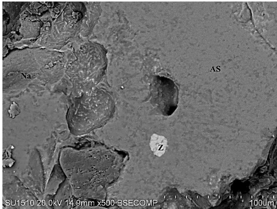
Şekil 4. 46. Oksijen atmosferinde korozyon testi yapılan %10 1050 HDAK kodlu şamot refrakter malzemesinin cürufa yakın 1. bölgenin geri yansıyan elektron görüntüsü (500×)
